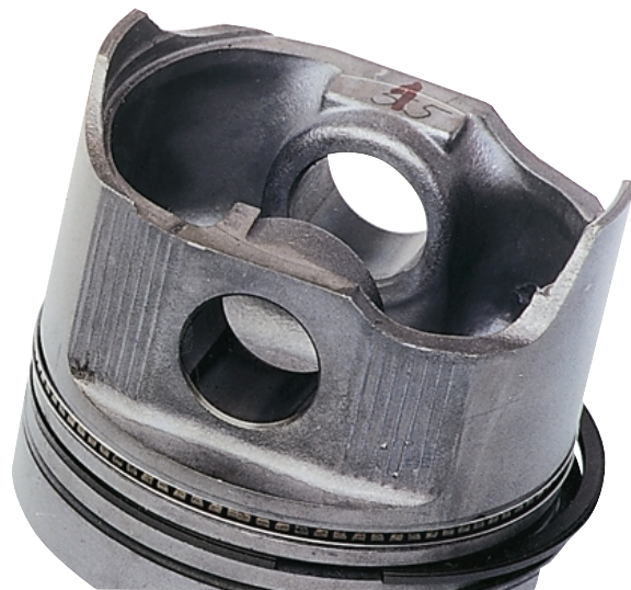
б) новый поршень требует прессовой посадки пальца в шатуне.
