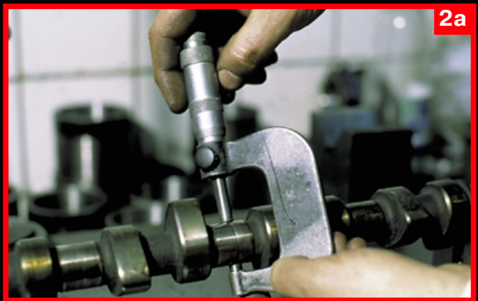
2. Зазоры и износы в подшипниках распредвала измеряются микрометром (а)
