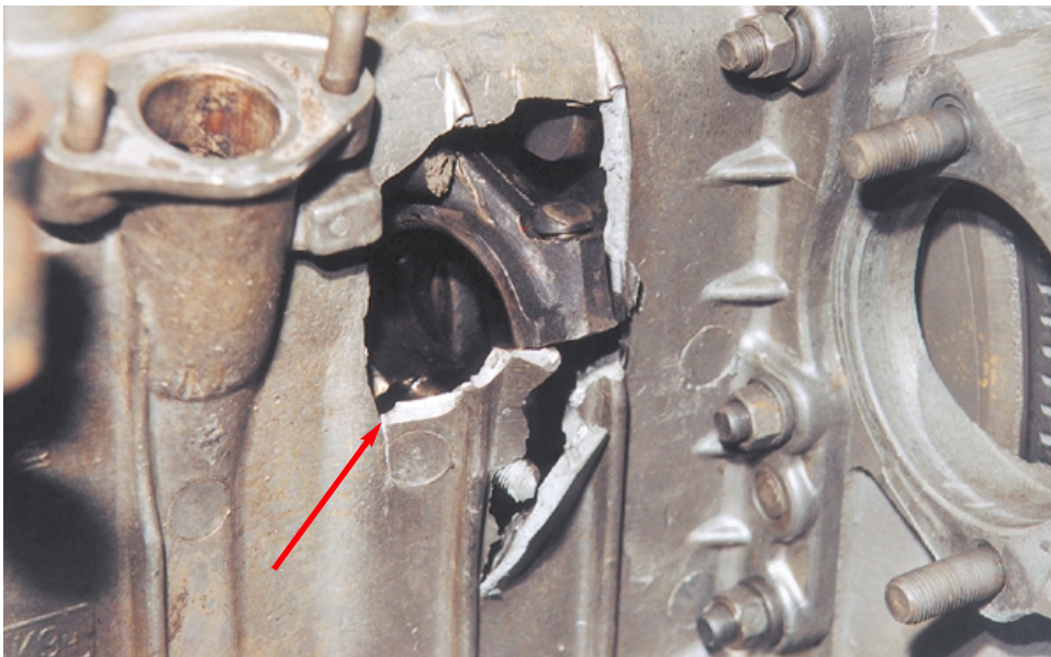
Разрушившийся шатун легко пробивает стенку любого блока цилиндров.
