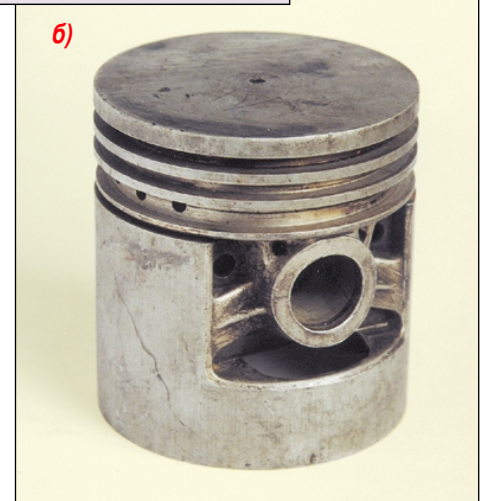
Изготовленный заново поршень (а) имеет более современный вид, чем «родной» (б), но оба они — от мотора М136.
