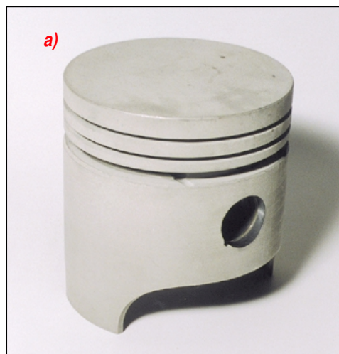
Изготовленный заново поршень (а) имеет более современный вид, чем «родной» (б), но оба они — от мотора М136.
