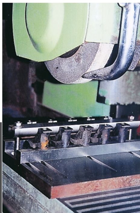
Обработка плоскости крышек «пакетом» на плоскошлифовальном станке позволяет добиться высокой точности и производительности.
