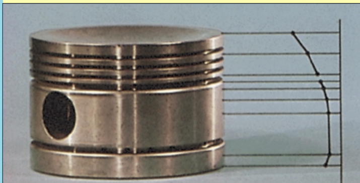
Поршень Mahle для авиационного двигателя 30-х годов уже приобрел вполне современную форму, включая профиль наружной поверхности (справа)
