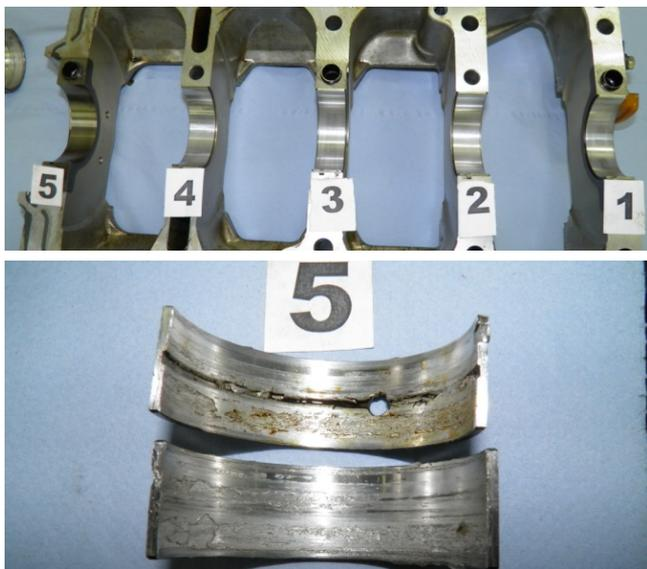
**Дефект серийного производства** – отверстие задней коренной опоры подшипников коленчатого вала в блоке цилиндров бензинового двигателя овальной формы и имеет размер меньше номинального на 0,050 мм (следствие недостаточной затяжки болтов перед растачиванием отверстий опор).
