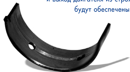
Глубокая борозда в середине вкладыша — типичный результат некачественной мойки или вообще ее отсутствия.
