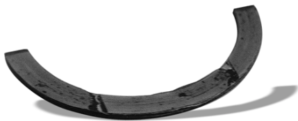
Вместо стандартных полуколец кто-то «забил» ремонтные. Их, естественно, «задрало» вместе с упорными поверхностями на коленвале.
