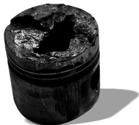
Клапан установили в направляющей втулке почти без зазора. Заклинить он был просто обязан. И разбить поршень тоже.
