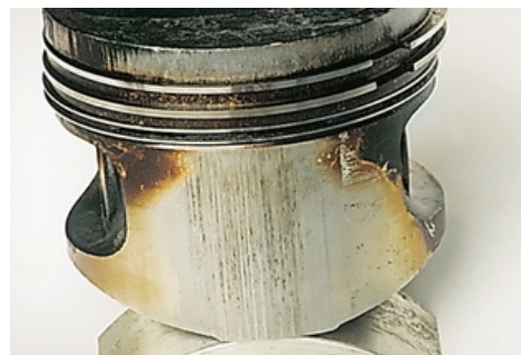
Если зазор между поршнем и цилиндром сделать слишком малым, задиры поршня и выход двигателя из строя будут обеспечены.
