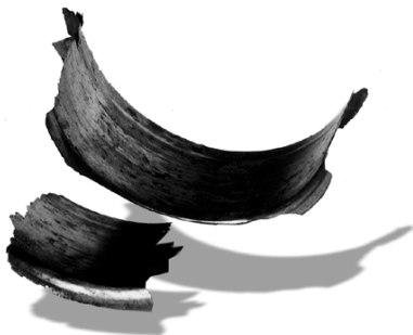
Расплавленный вкладыш — результат неосторожного обращения с герметиком.
