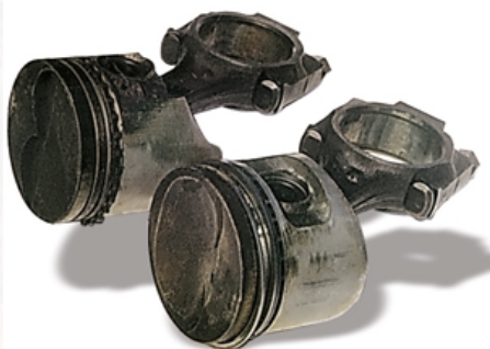
Совершенно разные поршни стояли в одном двигателе. Для чего это сделано, наверное, не расскажет и сам «автор» этого рацпредложения.
