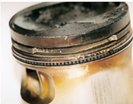
Регулировка опережения зажигания — «мелочь», из-за которой легко сломается перемычка на поршне.
