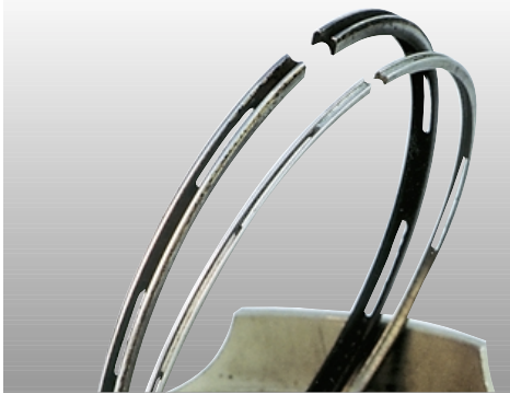
Разница в поршневых кольцах (слева) и пальцах (справа) заметна сразу: маслосъемное кольцо для спортивного мотора вдвое тоньше, а палец меньше диаметром и короче.
