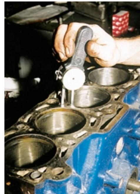
Прежде чем растачивать блок, необходимо определить, хватит ли толщины стенок.
