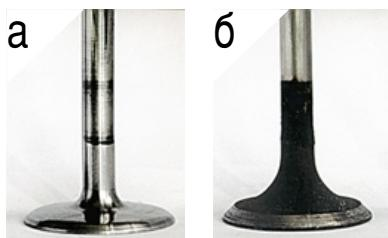
Доработанный впускной клапан (а) по сравнению со стандартным (б) имеет более тонкую тарелку и плавный переход к уплотнительной фаске. Это увеличивает наполнение цилиндра.
