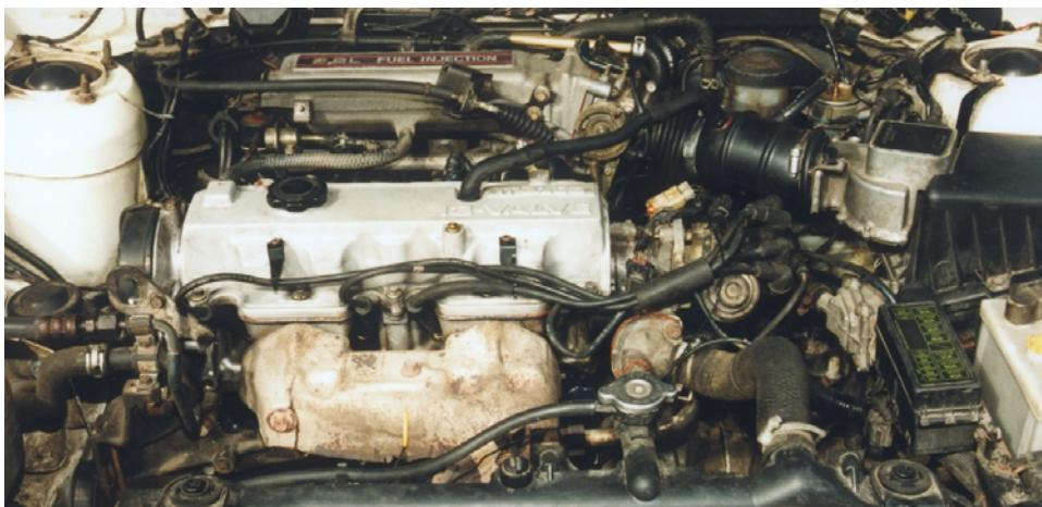
Так теперь выглядит подкапотное пространство автомобиля Mazda-626 с форсированным двигателем 2.4 л 12 клапанов. От стандартного мотора остался только блок цилиндров.
