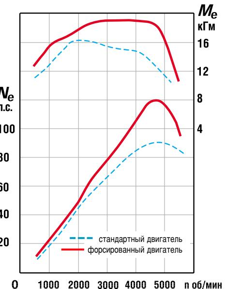
Крутящий момент M<sub>e</sub> и мощность N<sub>e</sub> у форсированного двигателя в целом значительно возросли, особенно на средних оборотах. Однако на высоких оборотах сказалось несоответствие прежней системы управления новому двигателю.
