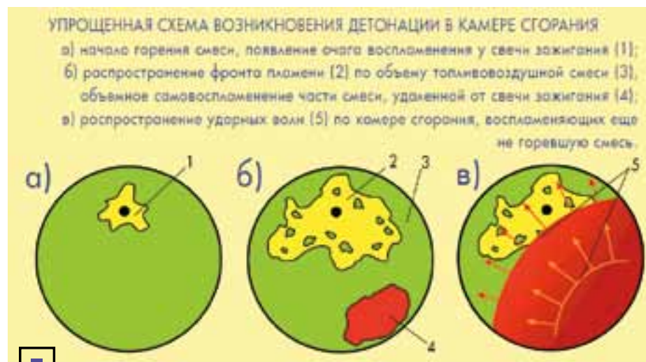
□ Детонация вызывает развитие ударной волны в цилиндре — именно ее и слышит водитель. Или не слышит...
