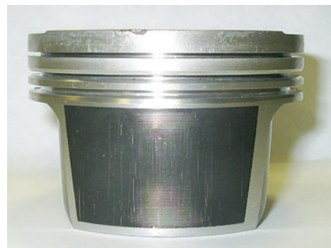
Поршень одной из уважаемых зарубежных фирм. Несмотря на антифрикционное покрытие, после 120 000 км пробега произошел сильный износ поверхности юбки на ненагруженной стороне (слева). Причина — отсутствие конструктивных мер для подачи смазки в зону трения при движении поршня вверх. Как говорится, «и на старуху бывает проруха».
