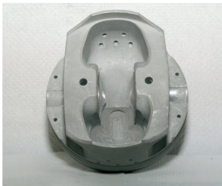
Топ-версия современного спортивного поршня. Ярко выраженная Т-образная форма, два поршневых кольца, предельно жесткая юбка с отверстиями для подачи масла.
