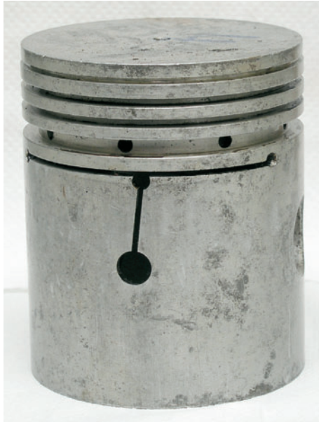
«Юбка с разрезом», толстые кольца и огромная компрессионная высота — характерные приметы старых поршней.
