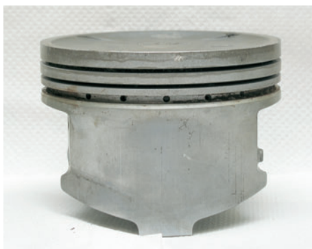
Поршень пока еще сравнительно высок и снабжен термокомпенсационными пластинами, но юбку уже подкрепляют ярко выраженные ребра.
