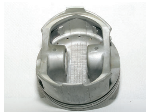
Поршень пока еще сравнительно высок и снабжен термокомпенсационными пластинами, но юбку уже подкрепляют ярко выраженные ребра.
