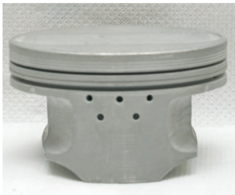
Топ-версия современного спортивного поршня. Ярко выраженная Т-образная форма, два поршневых кольца, предельно жесткая юбка с отверстиями для подачи масла.
