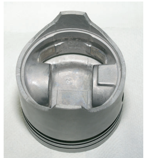
Поршень мотора Audi разработки 70-х годов. Термокомпенсирующий паз стал уже и переместился в канавку маслосъемного кольца. В конструкции также используются стальные термокомпенсирующие пластины. Заметна тенденция уменьшения высоты поршня.
