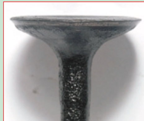
Одновременно изменилась геометрия фасок самих клапанов.
