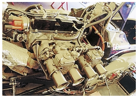
Прямые впускные каналы — обычное решение для гоночного двигателя. Карбюраторная система подачи топлива проста и надежна, но не очень точна.
