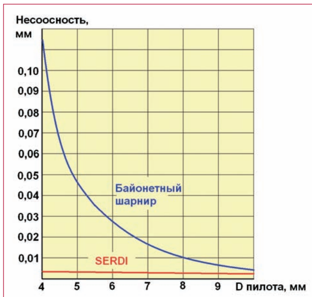
Результирующий график, показывающий несоосность обработанного седла в зависимости от диаметра пилота. Все-таки не «ударить» байонетом по современным мультиклапанам головкам блока.
