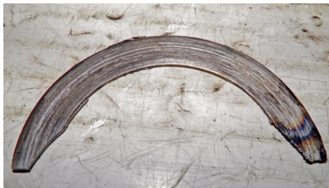
Из-за установки полукольца «задом наперед» его поверхность с фрикционным слоем не работала (слева), в то время как тыльная сторона протерлась (справа)
