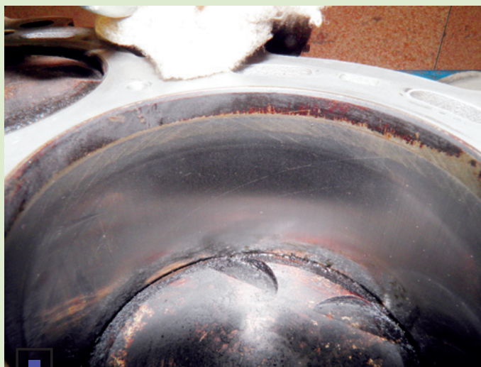
Вверху цилиндра, где обычно износ максимальный, хорошо видны хонинговальные риски. К середине выработка увеличивается
