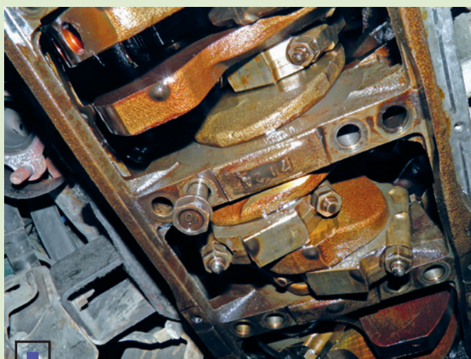
Постель коленвала представляет собой единую деталь
