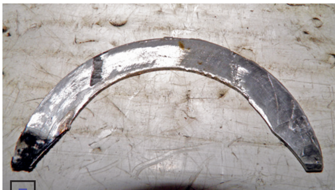
Из-за установки полукольца «задом наперед» его поверхность с фрикционным слоем не работала (слева), в то время как тыльная сторона протерлась (справа)
