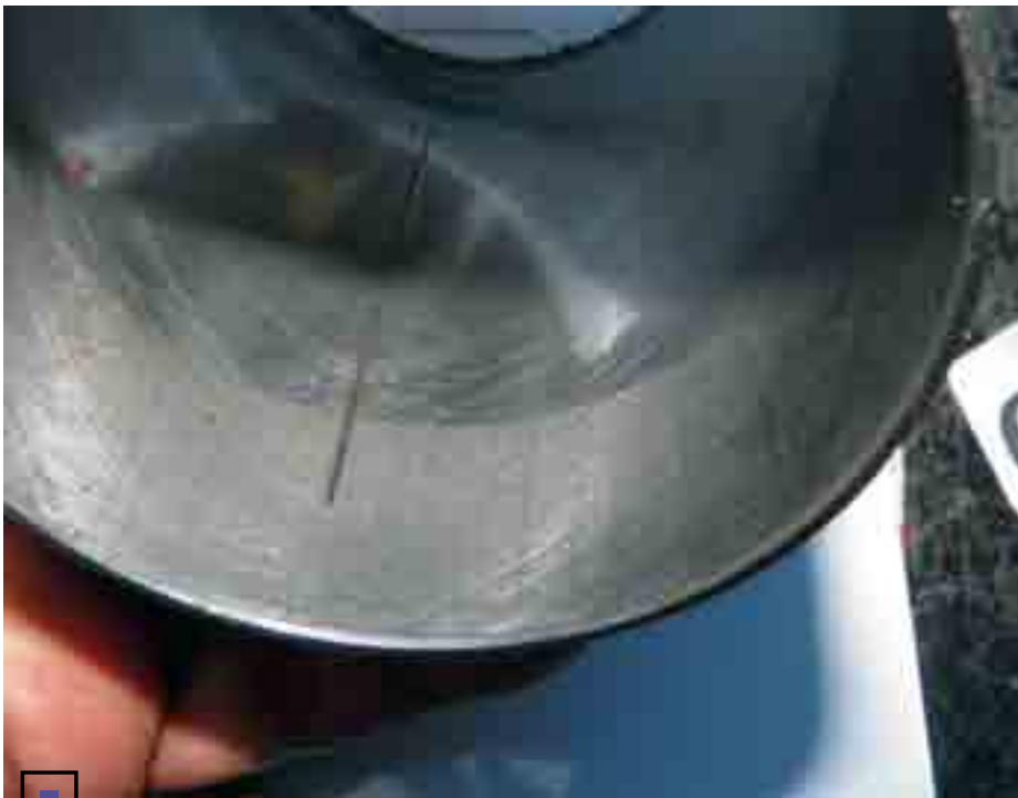
При сдвиге пальца упором служит поверхность цилиндра, где от пальца остается характерная «канавка»
