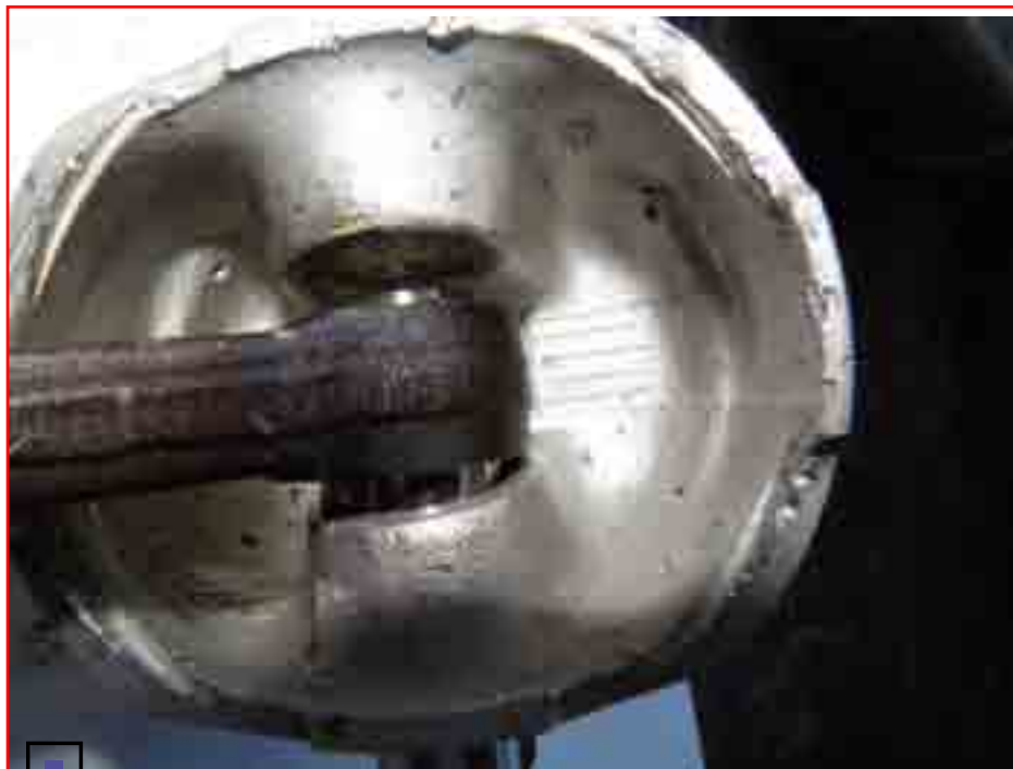
При сдвиге до упора палец теряет опору на одну из бобышек...
