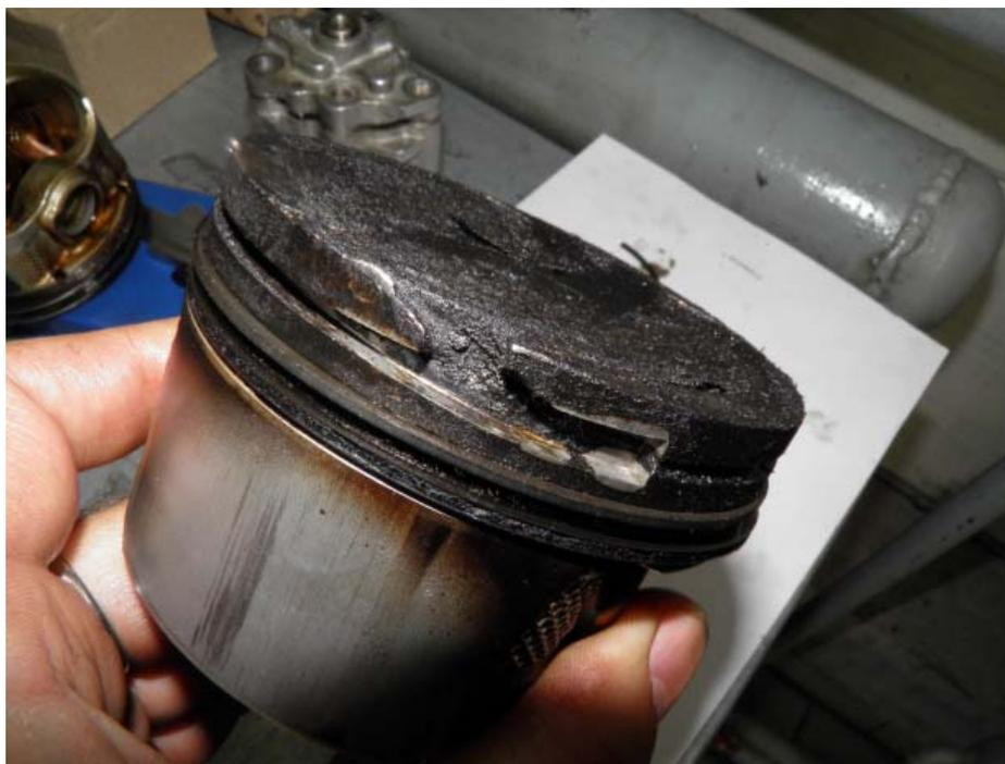
Этот исключительный случай произошел с легковым автомобилем, продуктом уважаемого японского автопрома. Именно тогда, когда пробег машины только перевалил за 50 000 км, ее современный 2,3-литровый мотор с турбонаддувом и непосредственным впрыском бензина забарахлил: начал расточительно расходовать масло (более 1,5 л/1000 км), а затем и вовсе «захромал» на один цилиндр.
