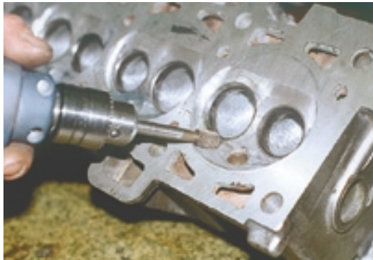
Помимо фрезеровки камера сгорания доводится вручную.
