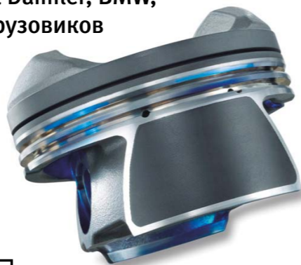
□ Поршень Nural EcoTough® с покрытием, содержащим «твердую смазку» — графит и дисульфид молибдена с углеродным волокном. Такая обработка существенно снижает потери на трение
