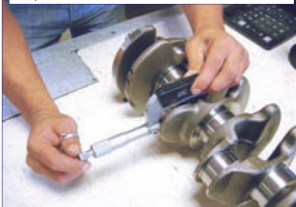
Микрометр — один из главных измерительных инструментов эксперта по двигателям
