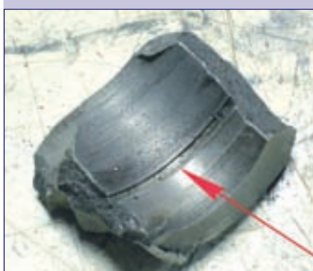
А вот и сам ключ — фрагмент бобышки поршня со следами сильной деформации наружного края канавки под стопорное кольцо
