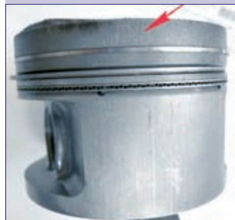
Абразивные частицы, попадая в цилиндр двигателя BMW из разрушенного катализатора, почти полностью «сели» боковые поверхности поршня. При этом верхнее кольцо в присутствии абразива заклинило в канавке, и поршень работал только со средним компрессионным кольцом.
