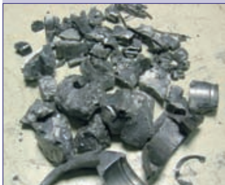
Кучка мелких обломков — все, что осталось от поршня двигателя КамАЗа. Однако среди них все-таки был найден ключ к разгадке причины выхода двигателя из строя.
