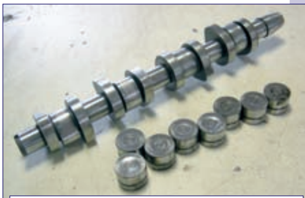
Износ распределительного вала и гидрокомпенсаторов дизельного двигателя VW произошел вследствие нарушения смазки.
