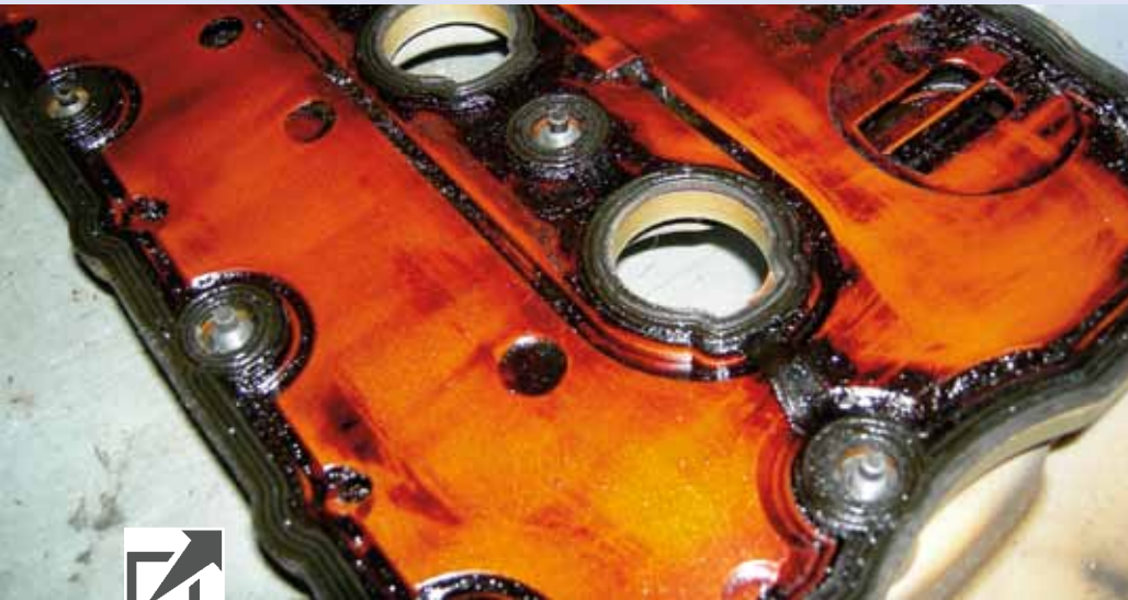
Следы нагара видны даже на клапанной крышке
