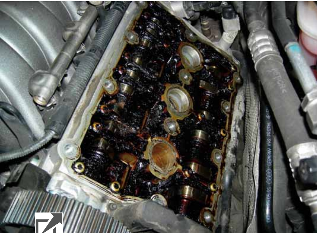
Распределительные валы «выработали» в нагаре что-то вроде тоннелей
