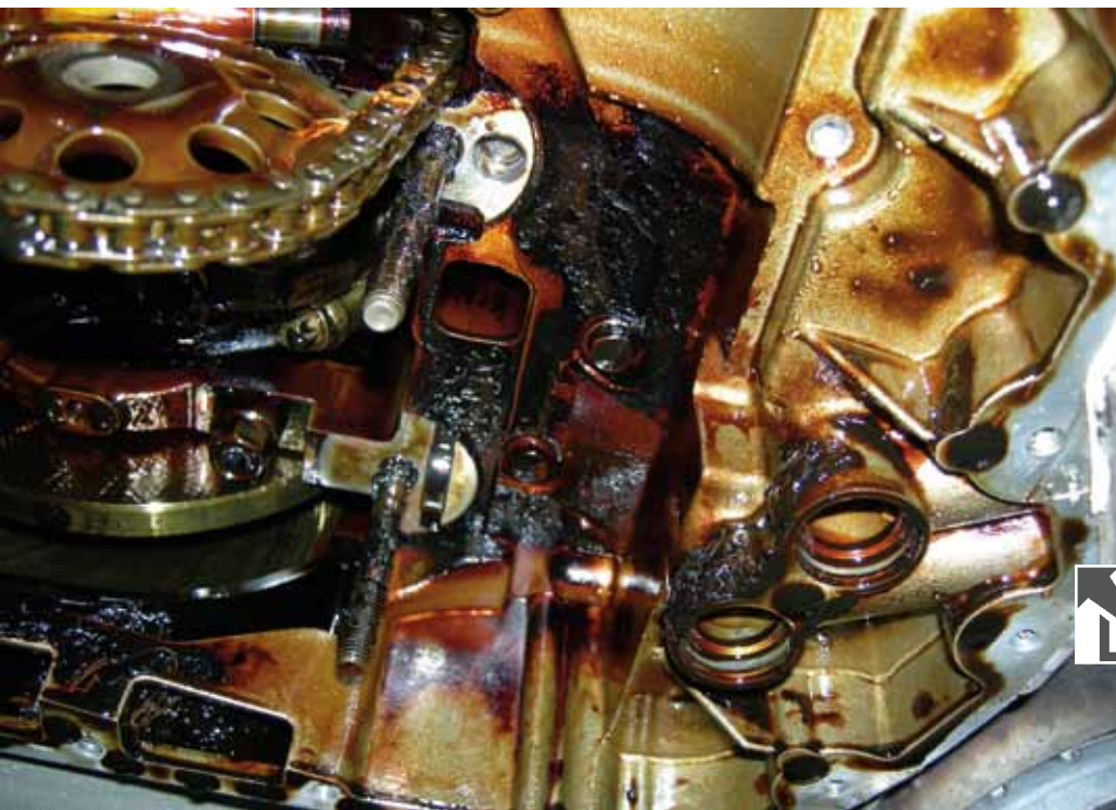
Распределительные валы «выработали» в нагаре что-то вроде тоннелей
