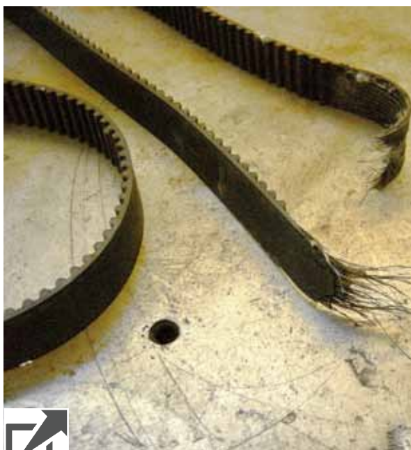
Когда двигатель заклинило, ремень ГРМ порвался
