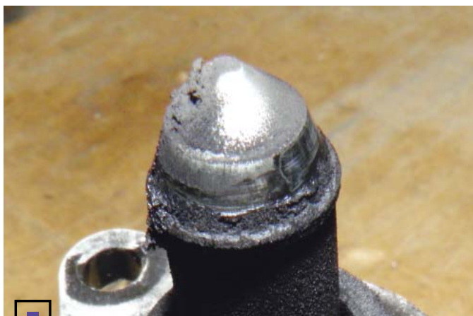
С одной стороны клапан холостого хода был покрыт толстым слоем нагара, а с другой блестел как после свежей обработки
