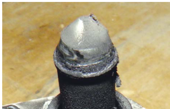
С одной стороны клапан холостого хода был покрыт толстым слоем нагара, а с другой блестел как после свежей обработки
