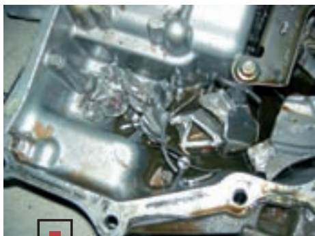
□ Типичная картина обломков поршня в поддоне вследствие обрыва клапана
