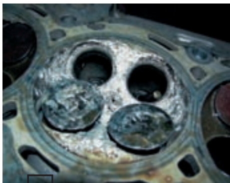
□ Клапаны действительно оборвались, но не от превышения оборотов...
