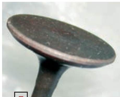
□ ...а в результате миллионов точечных контактов с поршнем, отполировавших край тарелки
