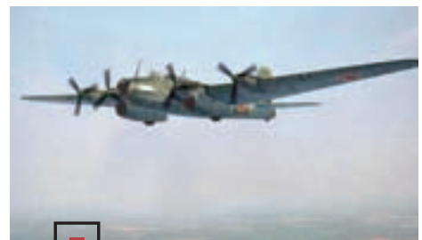
■ Усталость металла — штука более чем серьезная. Знаменитая советская «летающая крепость» — стратегический бомбардировщик Пе-8, строился с 1939 года, но, как оказалось, имел недостаточную усталостную прочность лонжерона крыла. Этот дефект впервые проявился только в 1944 году, когда усталость металла еще не была изучена. В 1945 году усталостное разрушение крыла привело к катастрофе, которая поставила крест на дальнейшей судьбе этого самолета
