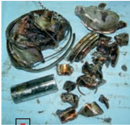
■ А этот поршень тоже разрушился, но по причине поломки шатуна в результате масляного голодания
