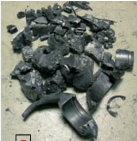
■ Все, что осталось от поршня. Но разрушился он совсем не от превышения допустимых оборотов, а в результате отсутствия стопорного кольца поршневого пальца
