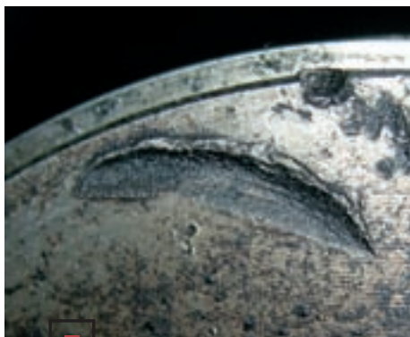
Ударная эрозия вызвала образование огромных цековок на поршнях, которые в 50 раз больше, чем способен сделать однократный удар тарелки клапана
