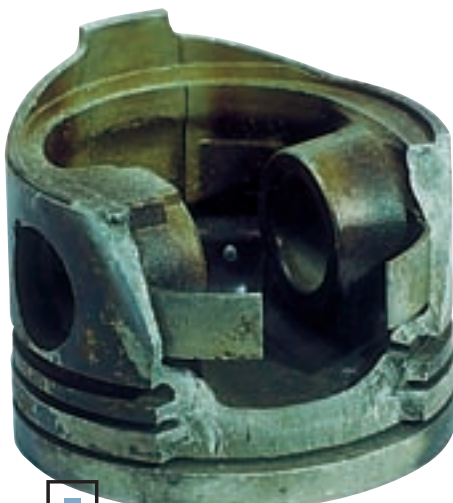
Все началось с трещины в перемычке, а закончилось поломкой юбки поршня
