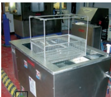
■ Ультразвуковая мойка применяется для чистки деталей сложной формы, с глубокими отверстиями и полостями.
