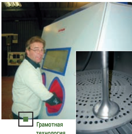
■ Эта установка специально предназначена для отработки технологии пескоструйной очистки.
