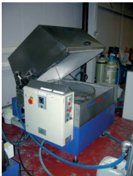
■ Машина, предназначенная для мойки деталей двигателя и агрегатов, полностью нержавеющая и оборудована масляным сепаратором, отделяющим до 98% масла.
