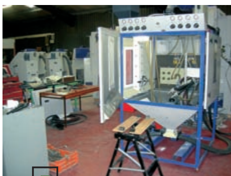
■ Эта установка специально предназначена для отработки технологии пескоструйной очистки.
