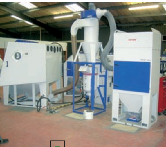
■ Система пескоструйной очистки с циклоном-рециркулятором и пылевым фильтром обеспечивает эффективную обработку при полной изоляции процесса от окружающей среды.
