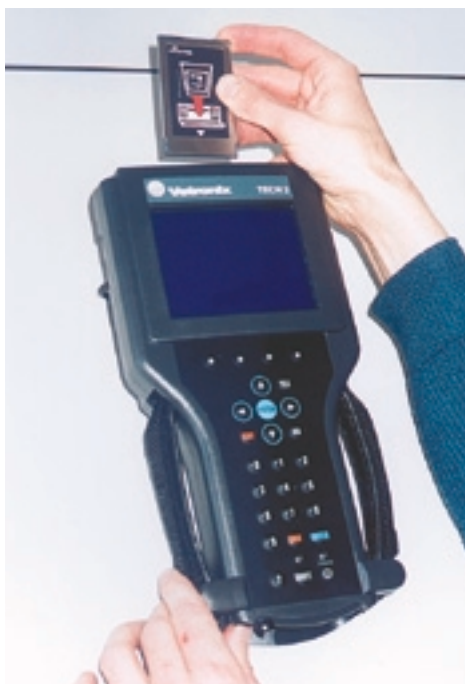
В дилерском сканере GM модели Tech-2 сменные программы поставляются на PCMCIA-картах. Это более удобно, так как позволяет пополнять или изменять хранящуюся на них информацию при помощи компьютера.
