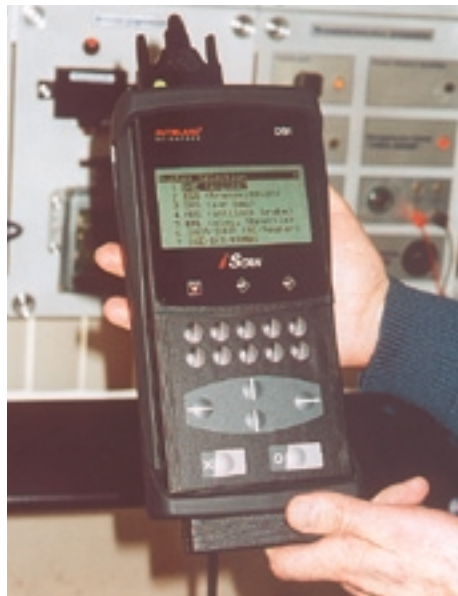
Несмотря на то, что у тайваньского сканера D 91 IScan программное обеспечение неясного происхождения, оно настолько тщательно отработано, что прибор заслужил доверие при диагностировании немецких автомобилей концернов MB, VAG, BMW.
