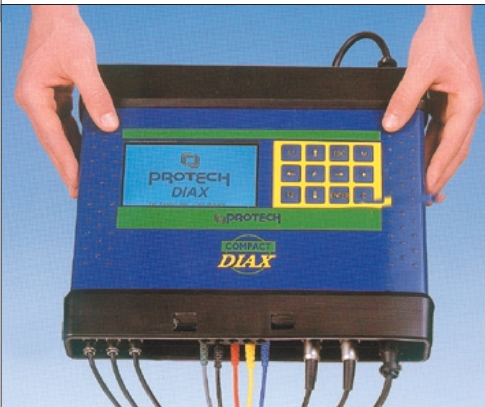
Compact DiAx итальянской фирмы Protech — экономичная модель компактного мотортестера. С функциональной точки зрения он не плох, может работать в комплексе с PC, газоанализатором, принтером. К сожалению, технические параметры осциллографа соответствуют невысокой цене прибора.
