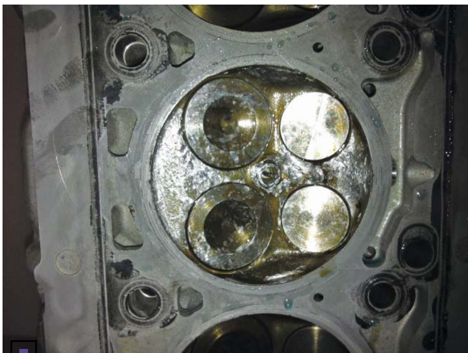
Удивительно то, что клапаны на «Мерседесе» остались не просто целыми, но и практически не деформированными
