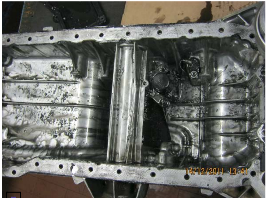
...От поршня остались лишь мелкие осколки на дне поддона
