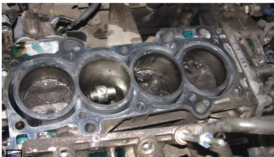
Как у «Мерседеса», шатун и палец на «Хонде» остались целыми, да и на стенках цилиндра лишь небольшие царапины
