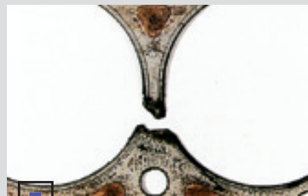
Прогар прокладки из-за нарушения процесса сгорания: а) по перемычке между цилиндрами; б) в рубашку охлаждения (видны следы эрозии окантовки)
