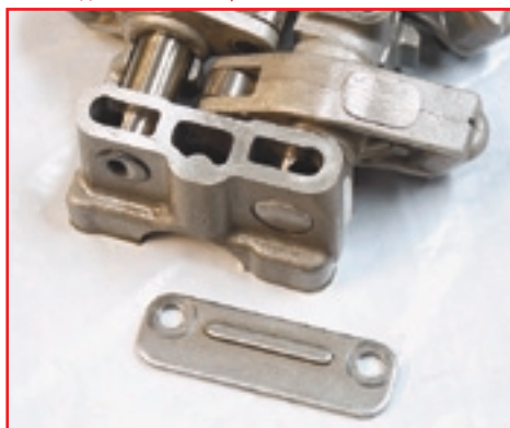
... достигнув верхней точки мотора в корпусе подшипников распредвала, масло возвращается в масляный канал головки блока и далее в блок, к натяжителю.
