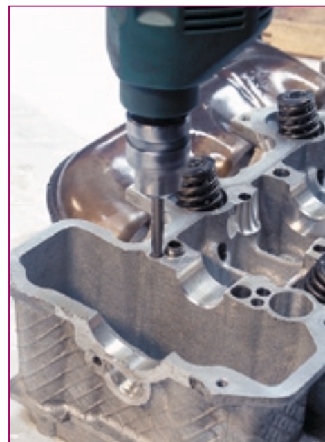
Не менять же головку, если ее можно легко «вылечить» с помощью дрели?!
