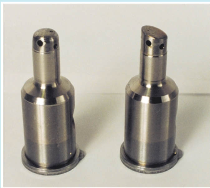
Форкамеры от более новых двигателей Mercedes (слева) не взаимозаменяемы с форкамерами старого образца (справа).
