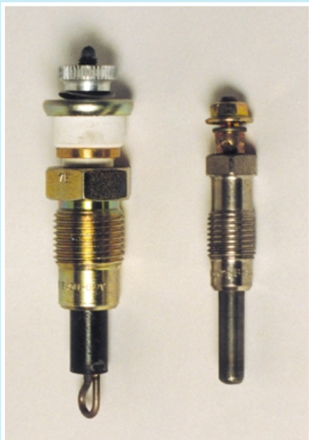
Свечи накаливания двигателей Mercedes выпуска до 1980 г. (слева) и после (справа).
