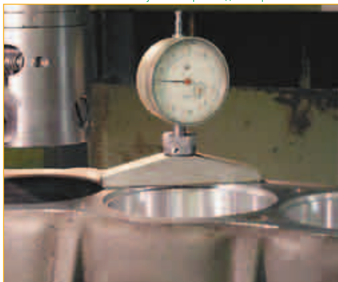
После растачивания цилиндра глубина выточки измеряется с точностью до 0,01 мм. Для этого удобно использовать глубиномер с индикаторной головкой.
