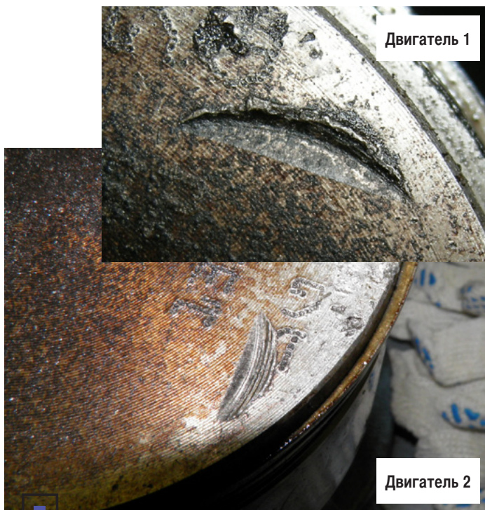
□ Глубокая ровная воронка в месте контакта клапанов с поршнями (справа) и четкая «лесенка» (слева) показывают на совершенно разную причину поломки
