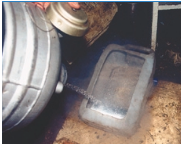
Жидкий азот для гильзы — отрада моториста!
