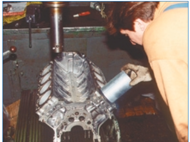
Самая ответственная операция для алюминиевой гильзы — поставить ее «от руки». Одно неверное движение — и гильза будет испорчена, а вся работа загублена.
