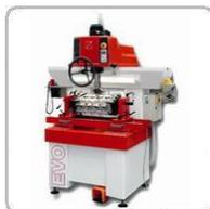
**EVO ML** – высокоточная машина с технологически совершенными решениями для обработки седел и направляющих втулок клапанов всех видов головок цилиндров
