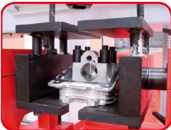
**Регулируемые выравнивающие опоры** – незаменимое средство для надежного зажима мотоциклетных и других головок цилиндра сложной формы.
