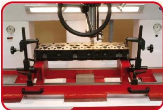
**Зажимное приспособление для плоских головок блока** – быстрое и удобное зажатие тяжелых плоских головок дизелей, отсутствие промежуточных деталей обеспечивает высокую жесткость и отсутствие вибраций при обработке.
