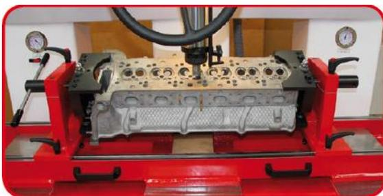
**Вращающееся на 360 ° зажимное приспособление** – удобное и надежное зажатие головок блока с наклонными клапанами, обеспечивающее высокую жесткость обработки.
