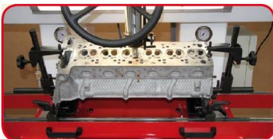
**Наклонное зажимное приспособление** – простое приспособление для наклона головок блока.
