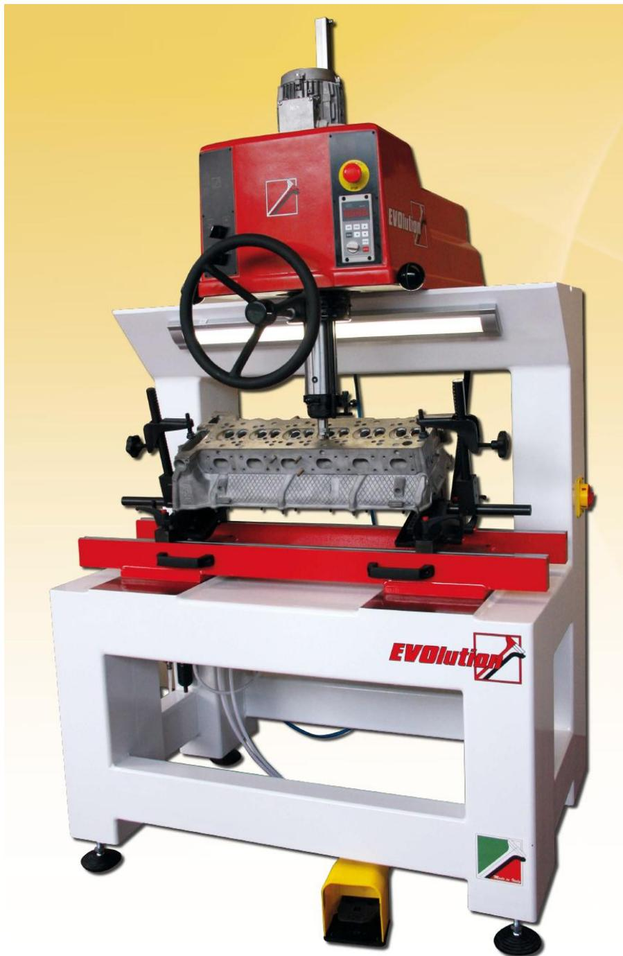
**EVO FC** – высокоточная машина с технологически совершенными решениями для обработки седел и направляющих втулок клапанов всех видов головок цилиндров.
