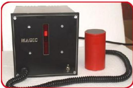
**"Волшебный" клинометр Magic** – прибор для мгновенной и точной установки головки блока в правильное положение, соответствующее вертикальному положению стержней клапанов. Незаменимая вещь для точной и быстрой работы.
