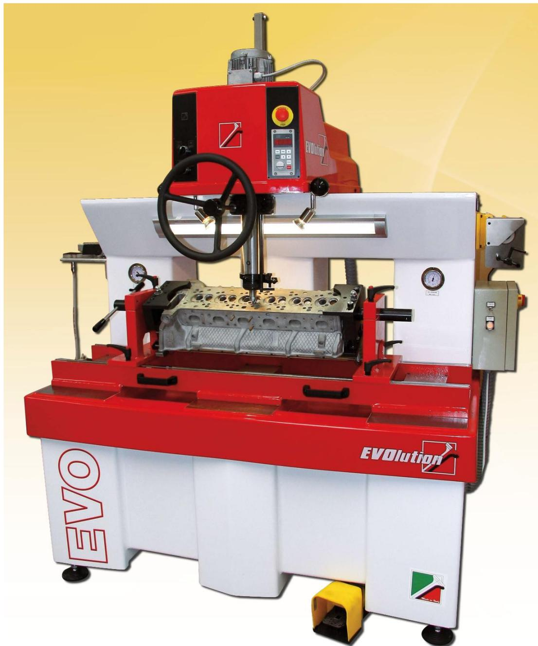
**EVO XL** – высокоточная машина с технологически совершенными решениями, задуманными для того, чтобы обрабатывать седла и направляющие втулки клапанов всех видов головок цилиндров.
