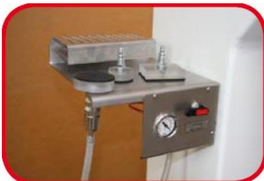
**Вакуумный тестер** – прибор для мгновенной оценки качества обработки седла, необходим для точной работы.
