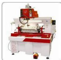
**EVO XL** – универсальный высокоточный станок для обработки седел и направляющих втулок клапанов всех видов головок цилиндров.
