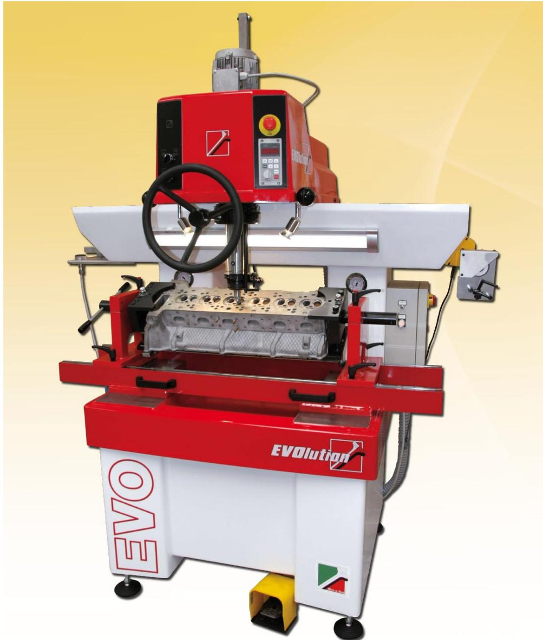
**EVO ML** – высокоточная машина с технологически совершенными решениями для обработки седел и направляющих втулок клапанов всех видов головок цилиндров.
