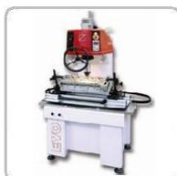
**EVO LIGHT** – жесткая и легкая в использовании высокоточная машина для обработки седел многоклапанных головок блока двигателей легковых автомобилей и мотоциклов.
