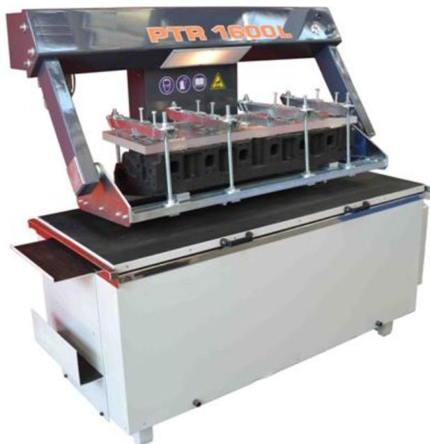
**СТАНОК ДЛЯ ПРОВЕРКИ НА ГЕРМЕТИЧНОСТЬ
