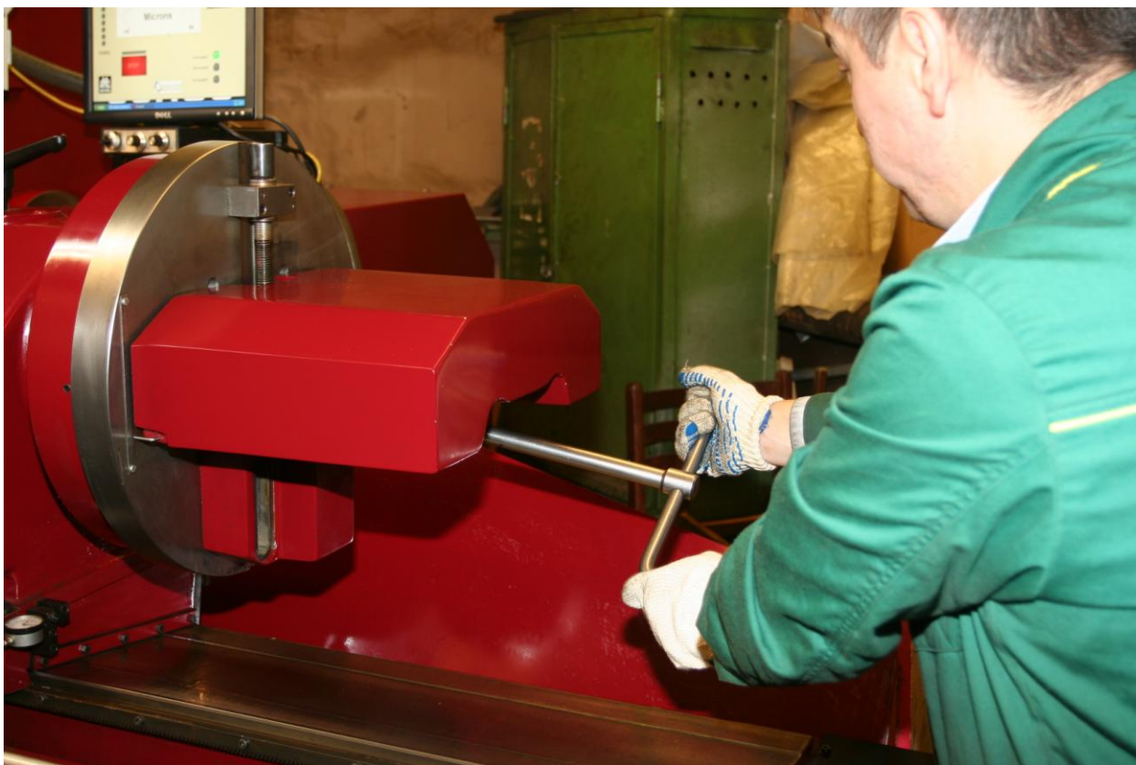
Рис. 2.4. Ослабить фиксирующие болты противовесов.
