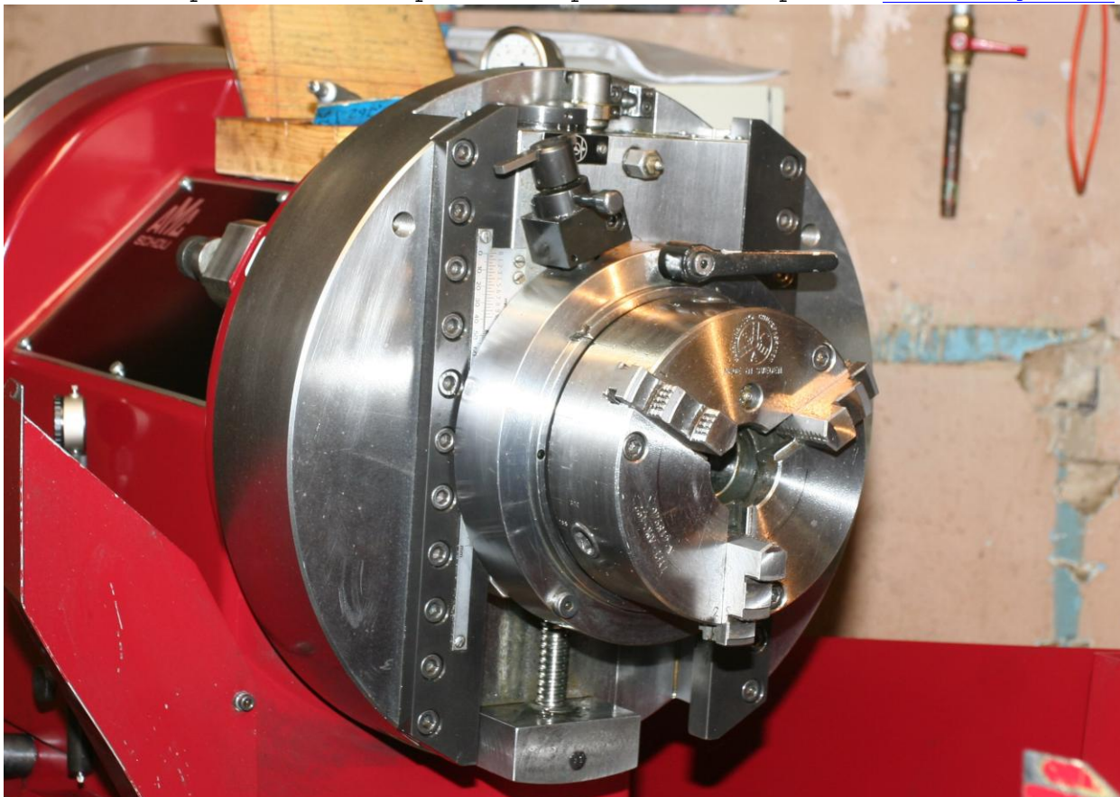
Рис. 2.3. Контролировать точное нулевое положение патронов по линейке на планшайбах.
