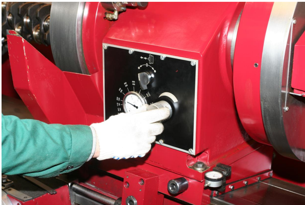
Рис. 1.16. Регулировка скорости перемещения планшайбы. Отрегулировать поворотом рукоятки. По окончании подачи планшайбы выключить подачу и затянуть фиксирующую рукоятку пиноли (сверху на задней бабке).
