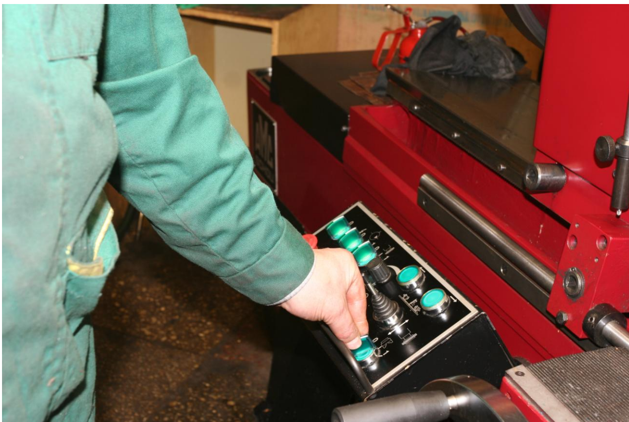
Рис. 1.35. Включить вращение и подачу шлифовального круга, а также вращение детали, и отрегулировать подачу охлаждающей жидкости. Установить брызговые кожухи.
