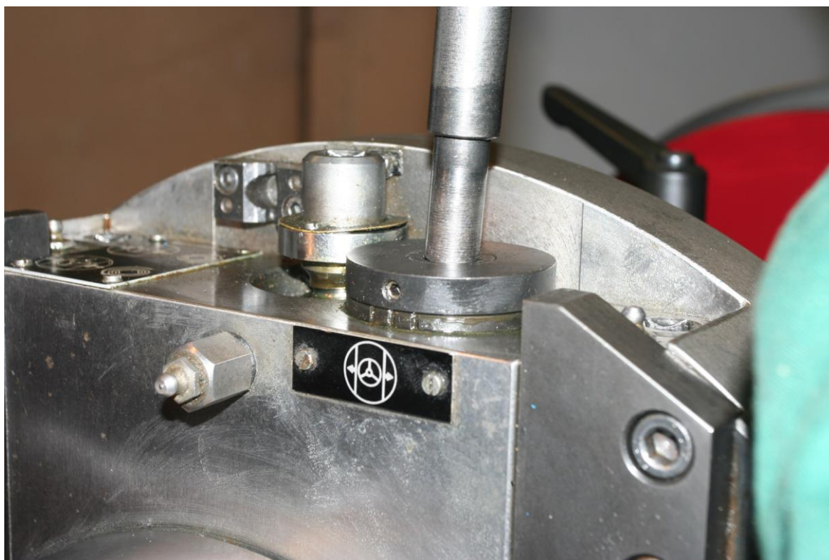
Рис. 2.10. Провести регулировку центров на минимальное биение (не более 0,01 мм), используя для смещения регулировочные болты продольного (в центре) и/или поперечного (показано на фото) смещения патронов.
