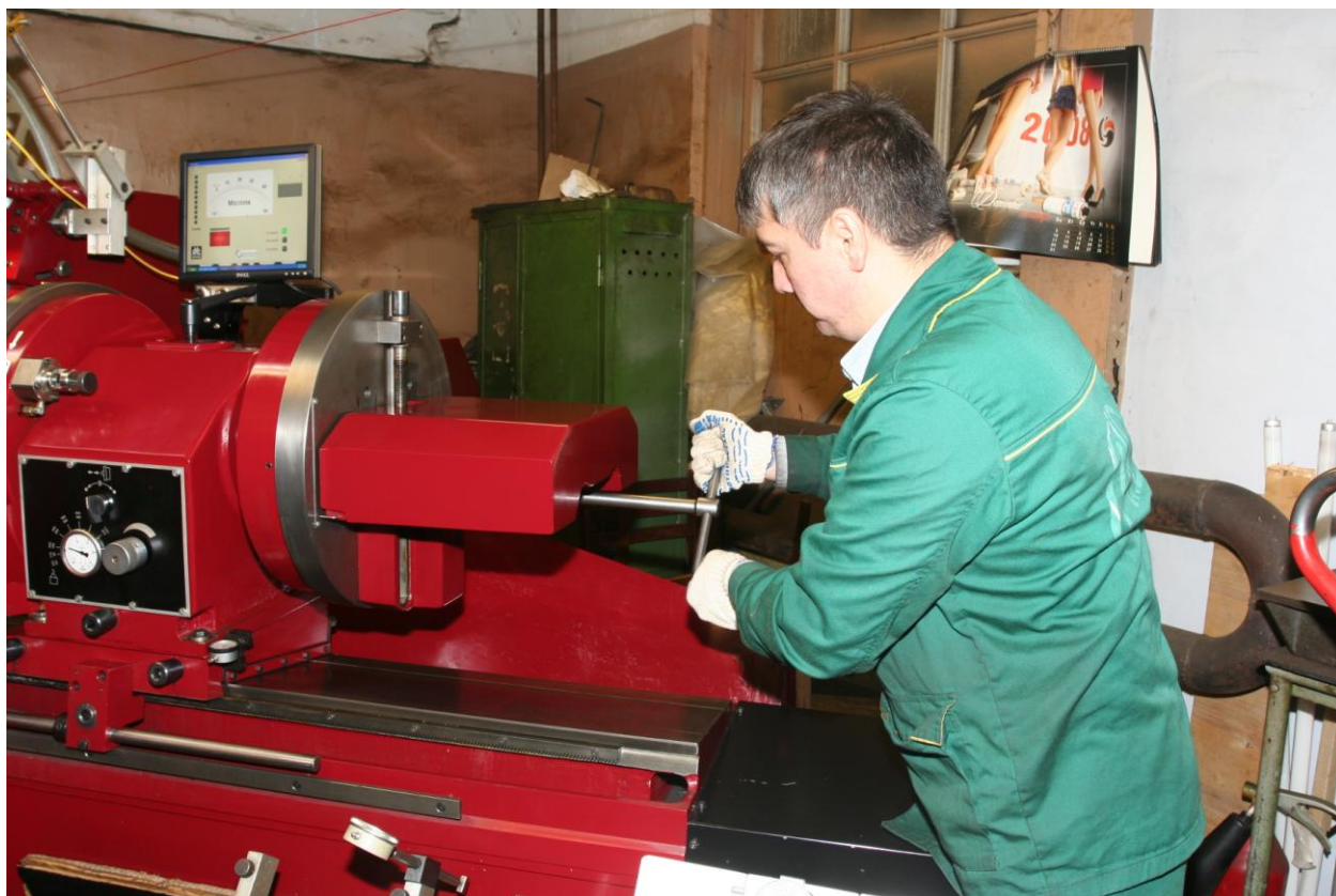
1.9. Ослабить фиксирующие болты противовесов.
