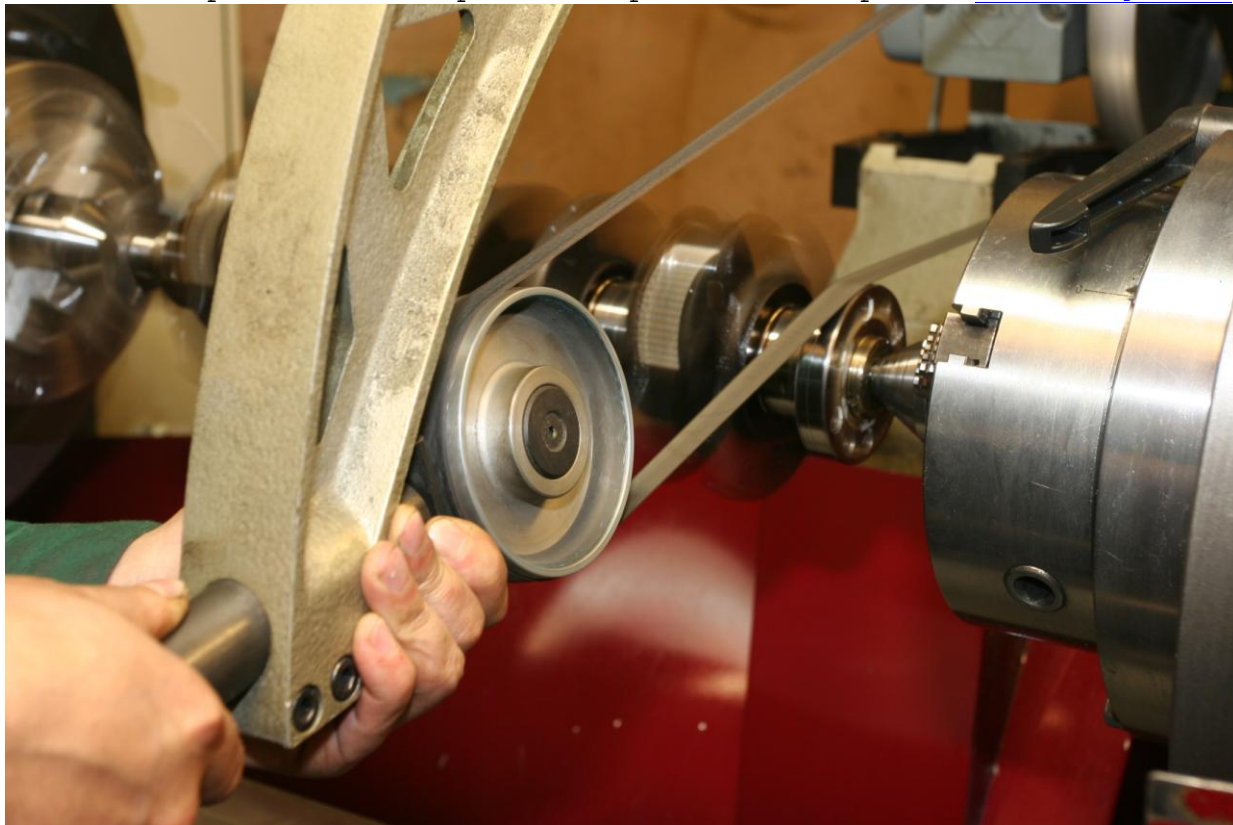
Рис. 2.23. Отполировать поверхности сальников.
