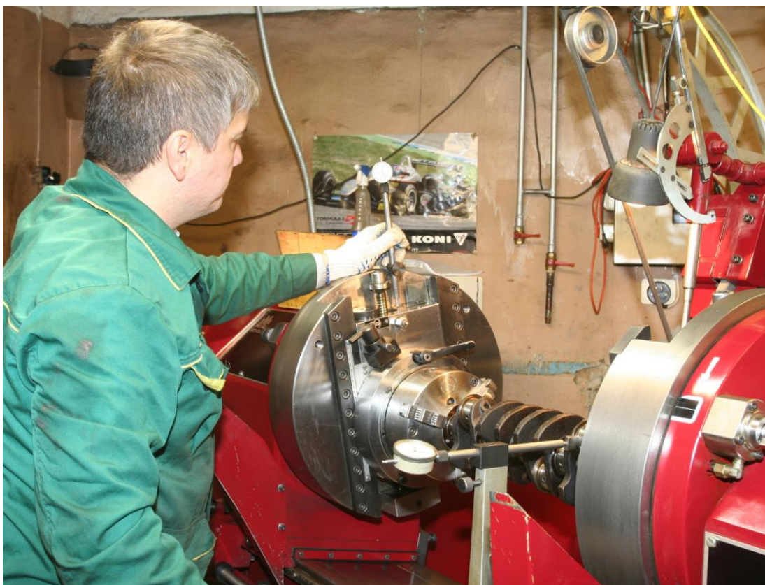
Рис. 1.26. Проверить точную величину смещения патронов передней и задней бабок с помощью индикатора (при наличии этой опции в комплектации станка). Если разница смещения превышает 0,05 мм, выполнить повторную регулировку положения вала.
