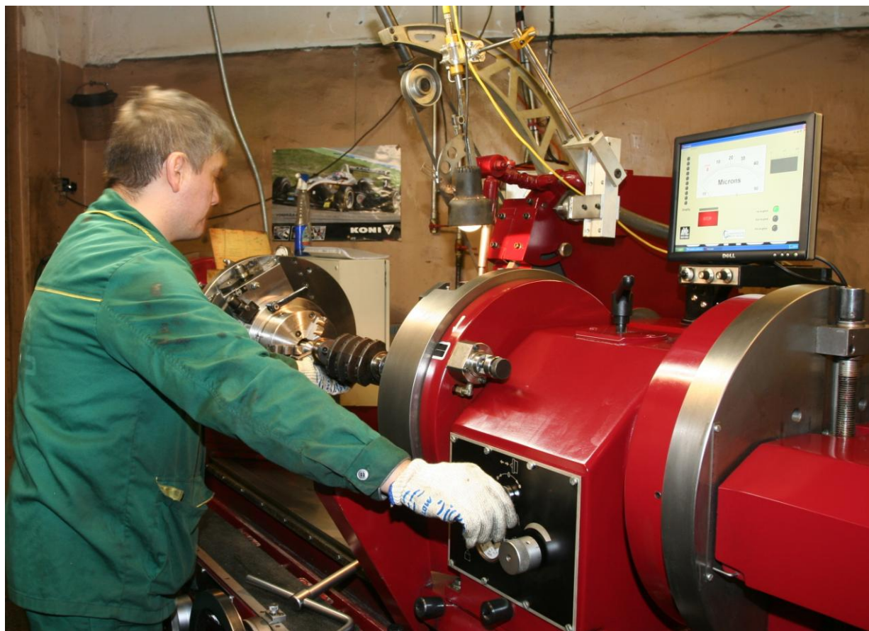
Рис.2.12. Установить вал в центра, включив перемещение планшайбы задней бабки.
