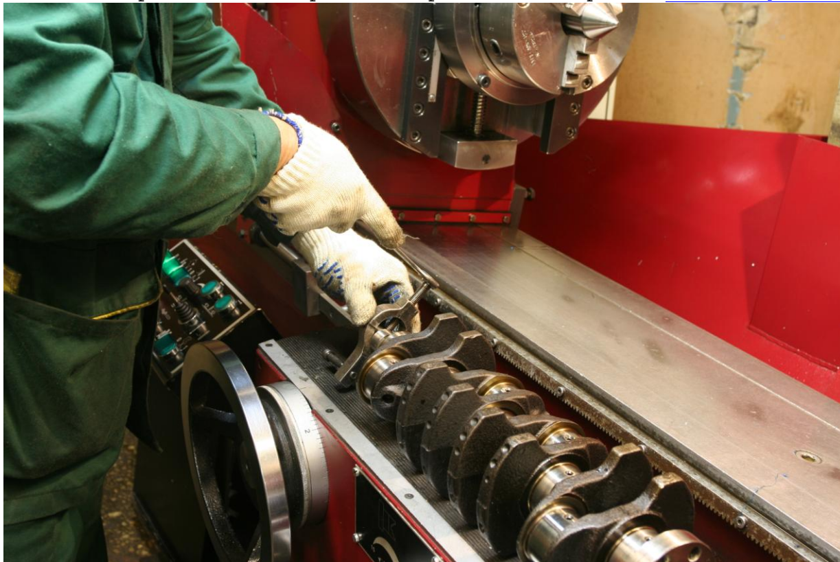
Рис. 2.11. Установить на хвостовик вала поводок.
