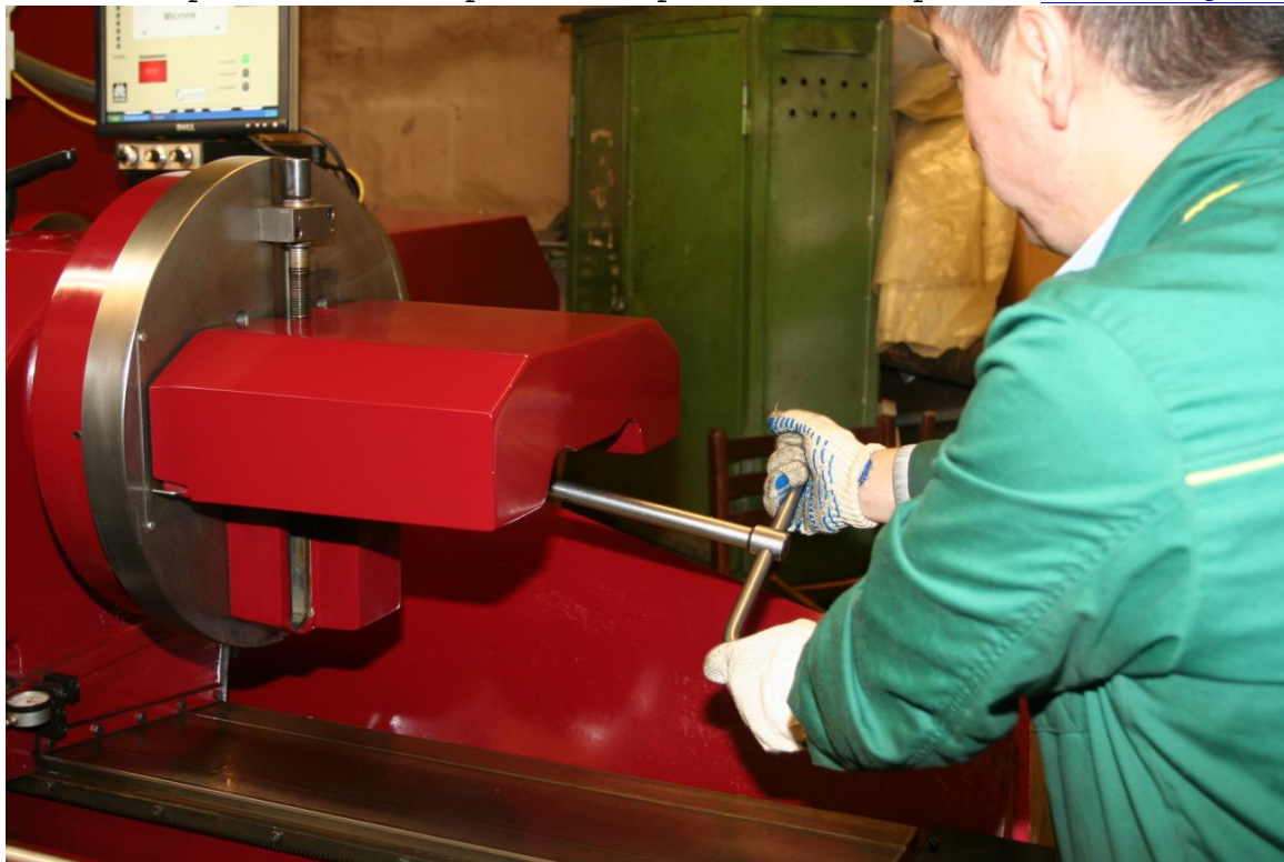
Рис. 2.7. Затянуть фиксирующие болты противовесов по окончании регулировки.
