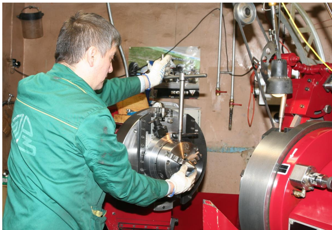
Рис. 2.8. Установить в патроны неподвижные центры с цилиндрическими хвостовиками (не входят в комплектацию станка, приобретаются отдельно).
