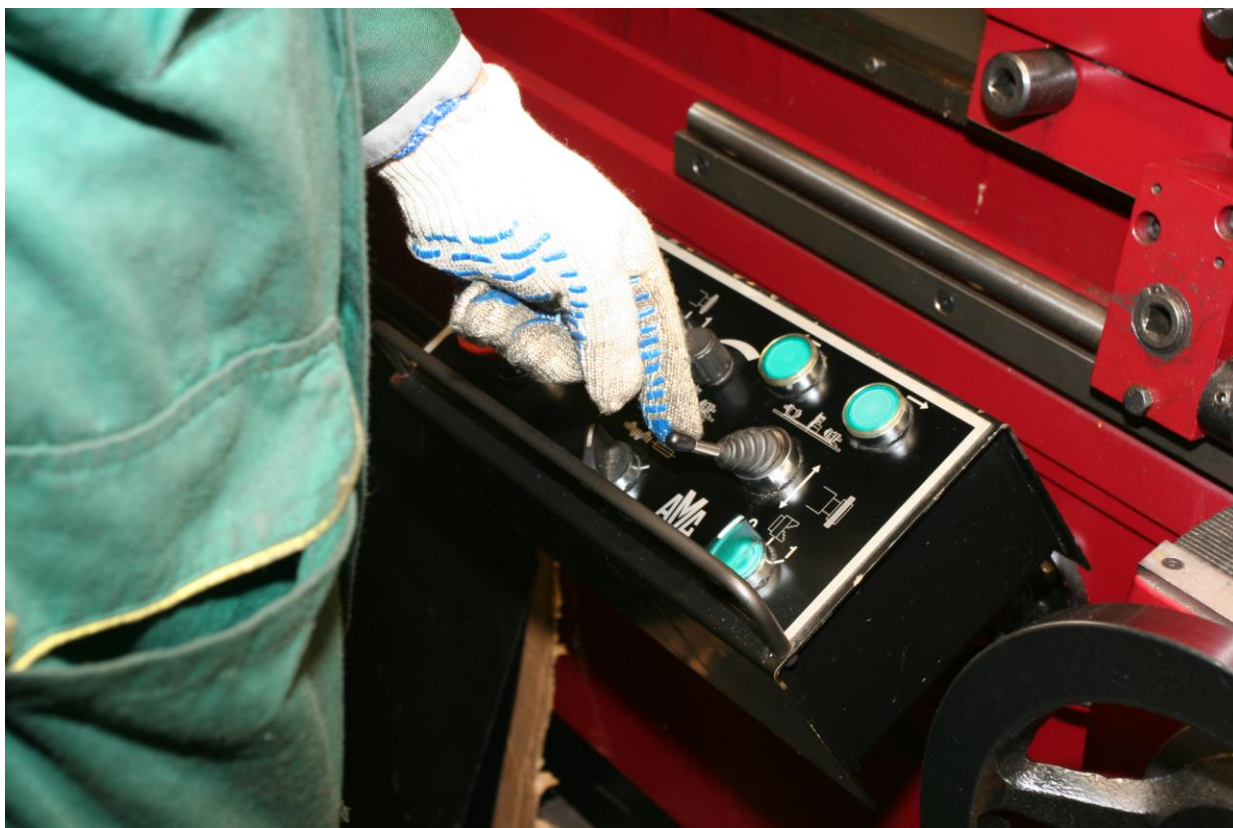
Рис. 1.31. Подать круг вперед, регулируя его положение маховиком справа от пульта.
