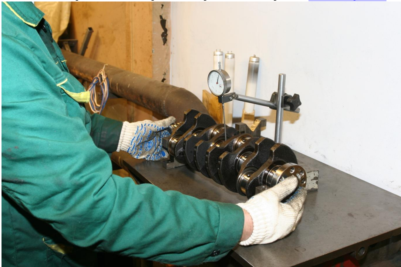
Рис. 2.25. Окончательный контроль вала — завершающий этап шлифовки вала. Контролировать биение коренных шеек и размеры всех шеек.
