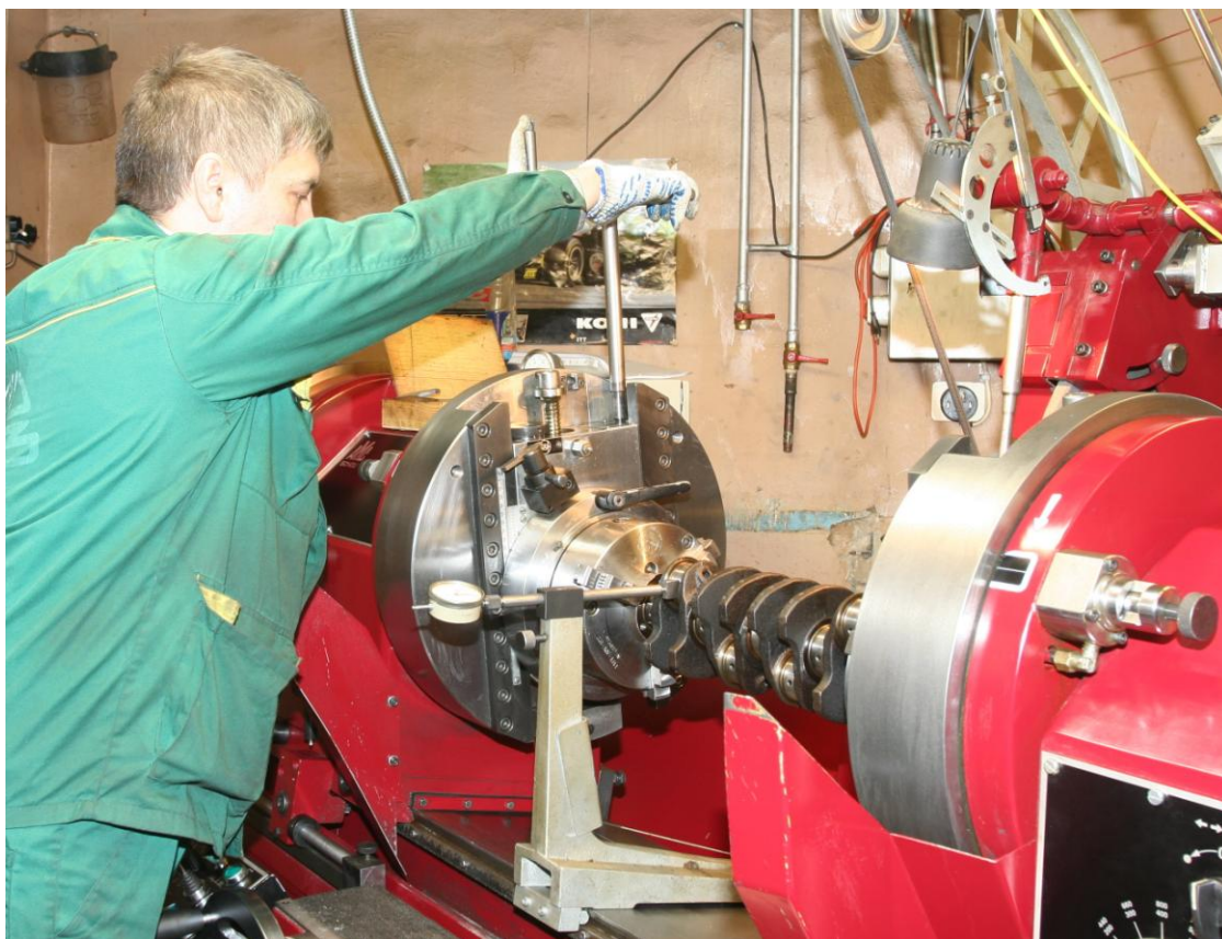
Рис. 1.27. Затянуть центросместительные системы передней и задней бабок. ВНИМАНИЕ: Категорически запрещается при затяжке болтов прилагать чрезмерные усилия во избежание повреждения деталей центросместителей и поломки болтов!
