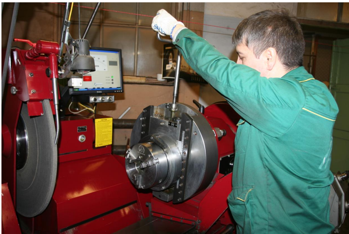
1.7. Сместить патроны на величину радиуса кривошипа вала вращением центрального болта.
