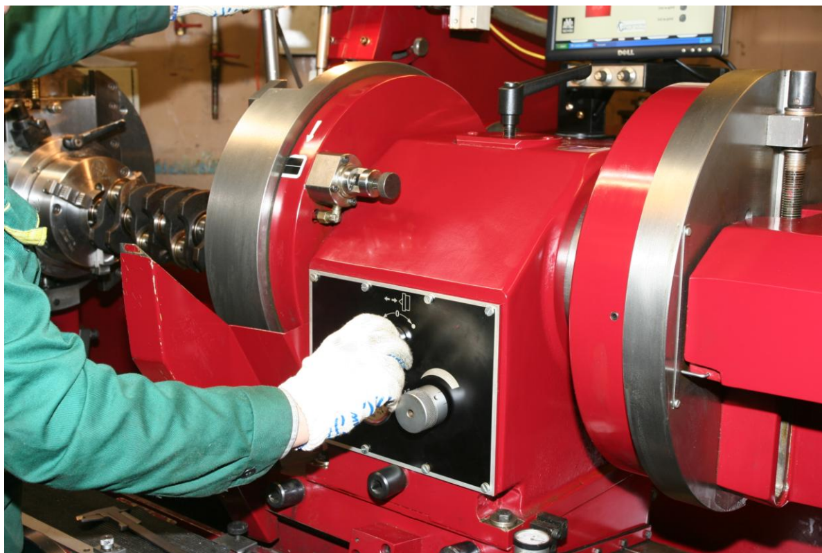
Рис. 1.15. Включить гидравлический подвод планшайбы задней бабки. Для облегчения установки вала задняя планшайба имеет гидравлический продольный ход 70 мм. Включение подачи обеспечивает движение патрона задней бабки в сторону вала до вхождения хвостовика в кулачки патрона задней бабки.
