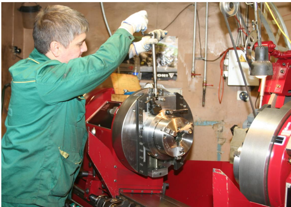
Рис. 2.2. Установить патроны на нулевое смещение от оси, вращая центральный регулировочный болт центросместительной системы.
