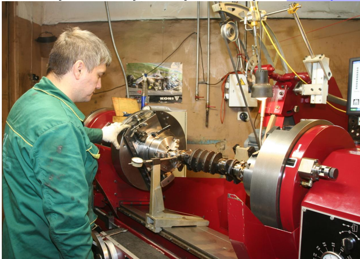
Рис. 2.15. Установить центроискатель на первую коренную шейку вала и проверить биение.
