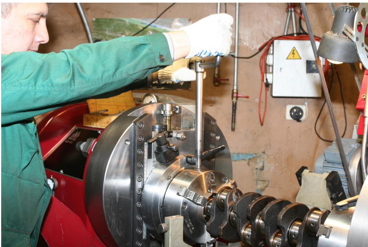
Рис. 1.22. Окончательно затянуть вал в патронах. При затяжке избегать чрезмерных усилий.
