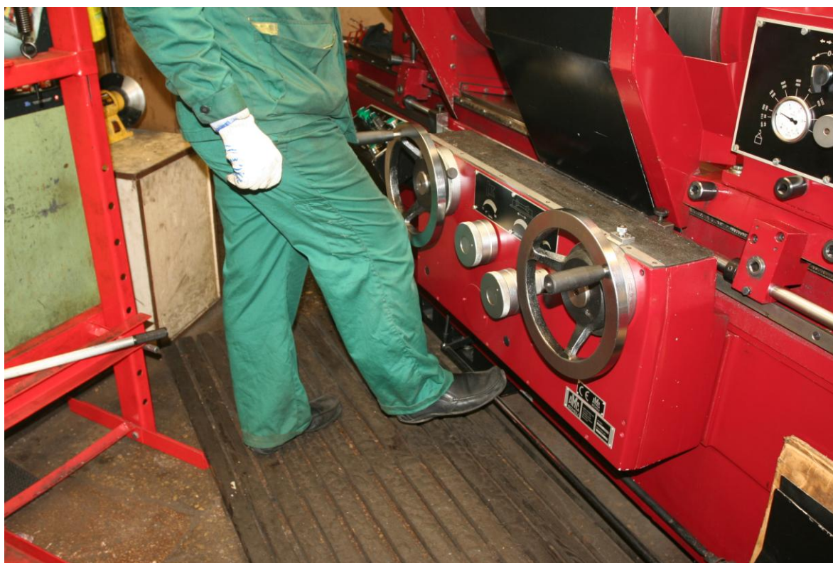
Рис. 1.28. Нажать на педаль и освободить планшайбы. При заблокированных планшайбах защита станка не позволит включить вращение вала.
