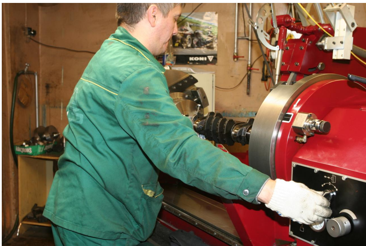
Рис. 2.24. Ослабить кулачки патронов и рукоятку пиноли задней бабки, отвести планшайбу и снять вал со станка.
