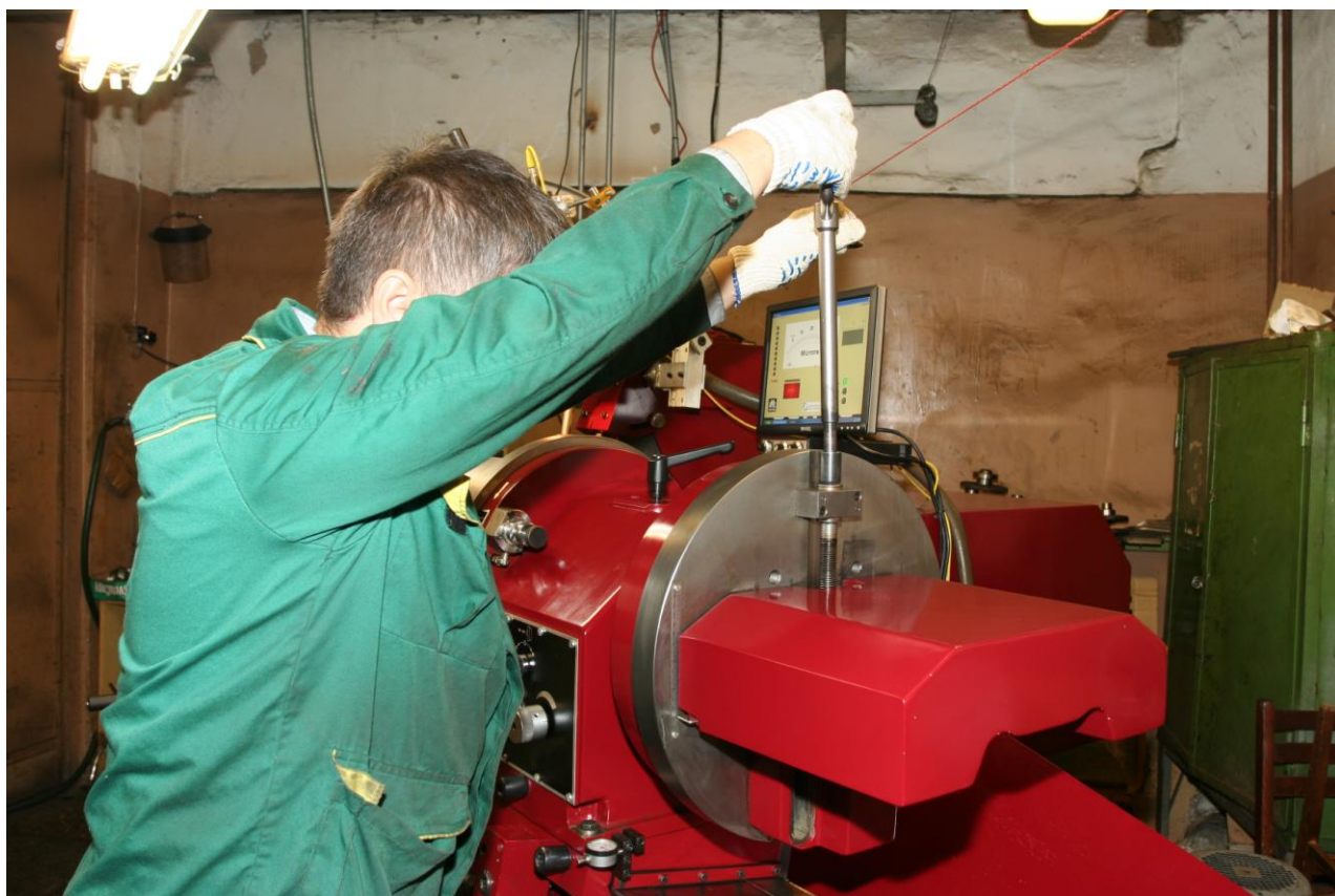
1.10. Сместить противовесы вращением регулировочного болта приблизительно на величину половины радиуса кривошипа.
