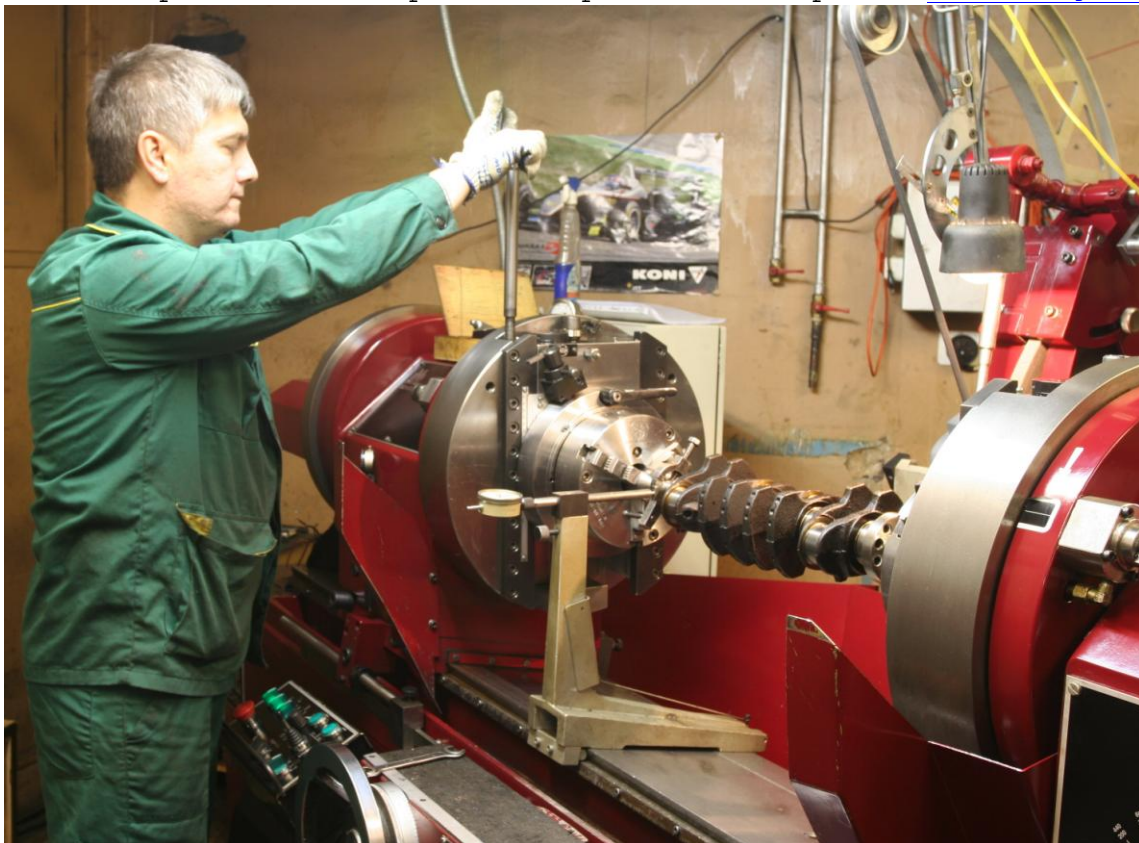
Рис. 2.17. Затянуть окончательно фиксирующие болты центросместительных систем. ВНИМАНИЕ: Избегать чрезмерного усилия затяжки во избежание поломки деталей и болтов.
