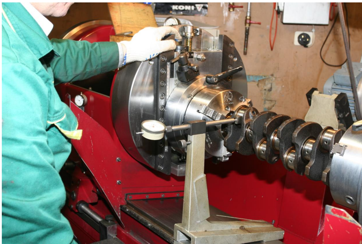
Рис. 1.23. Поставить центроискатель (прилагается к станку) на первую шатунную шейку. Нажать на педаль, чтобы освободить штифты планшайб. Провернуть вал, проверить биение шейки.
