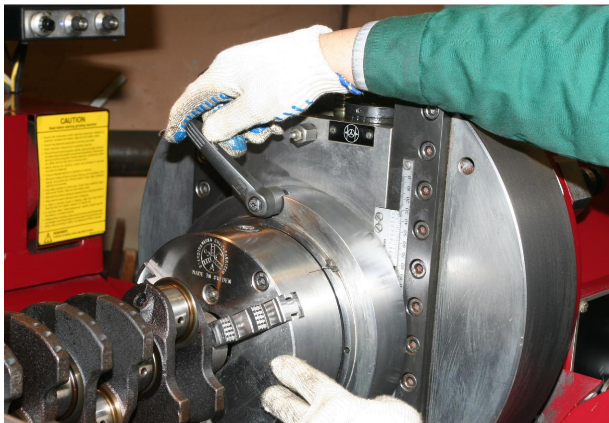
Рис. 1.20. Ослабить фиксирующую рукоятку патрона задней бабки и установить патрон в нулевое положение. Слегка затянуть рукоятку.
