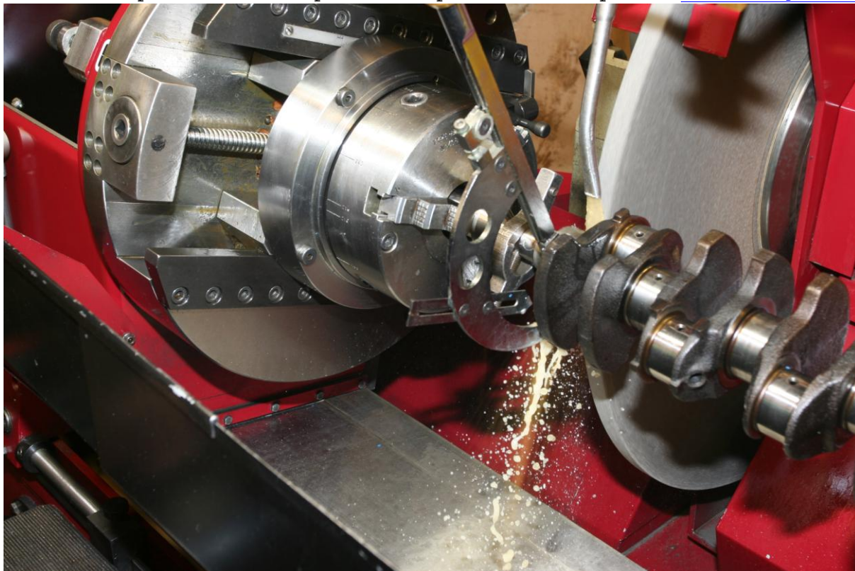
Рис. 2.19. Поставить брызговые кожухи, выполнить шлифовку шейки вала.
