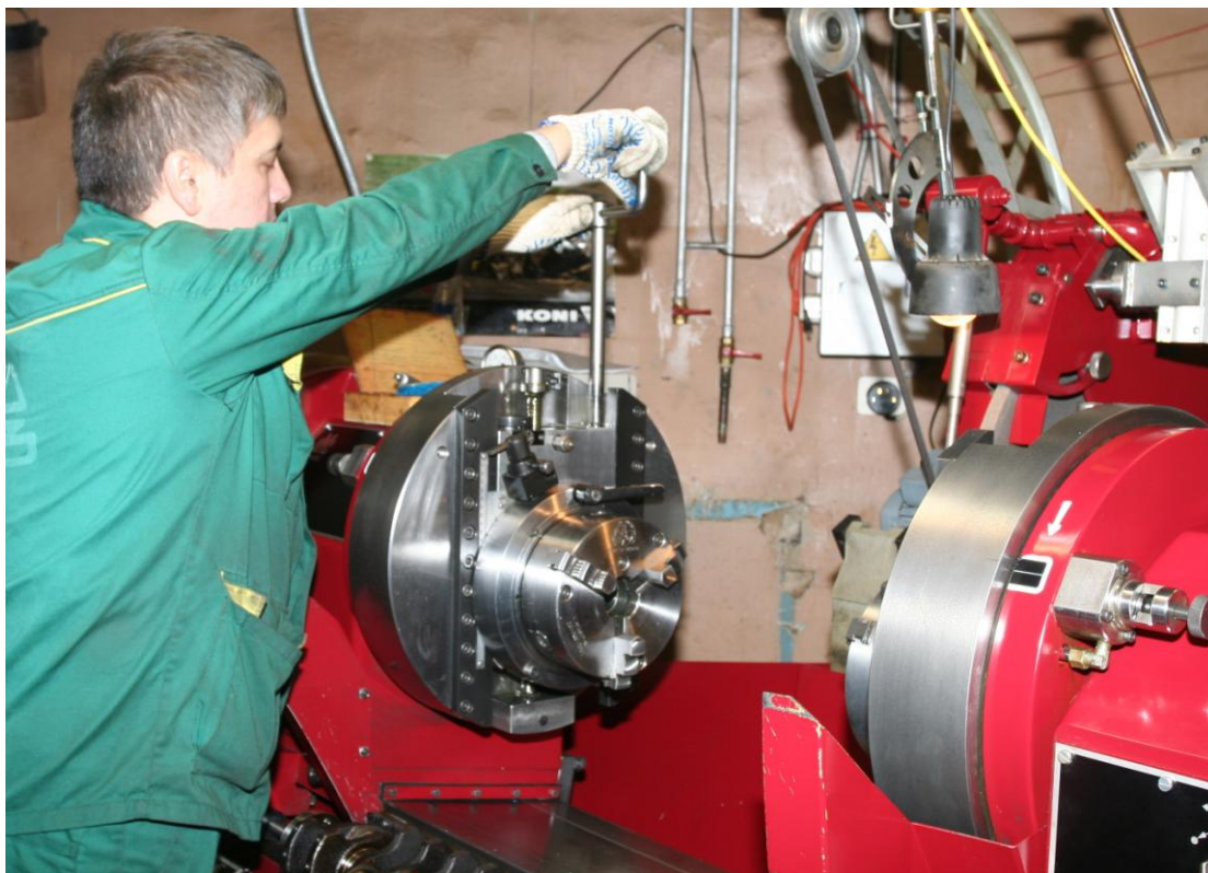
Рис. 2.1. Снять коленчатый вал, ослабить фиксирующие болты центросместительных систем.
