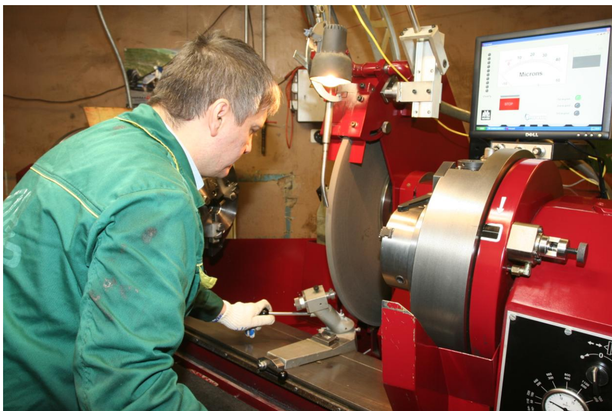
1.3. Правка радиуса круга. Используется приспособление для правки радиуса. Технология подробно описана в Инструкции по эксплуатации станка.
