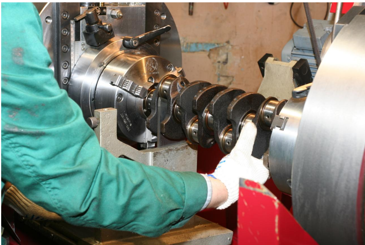
Рис. 1.21. Выровнять положение вала при слегка освобожденных кулачках патронов так, чтобы первая шатунная шейка расположилась строго вертикально, используя V-образное центрирующее приспособление, прилагаемое к станку.
