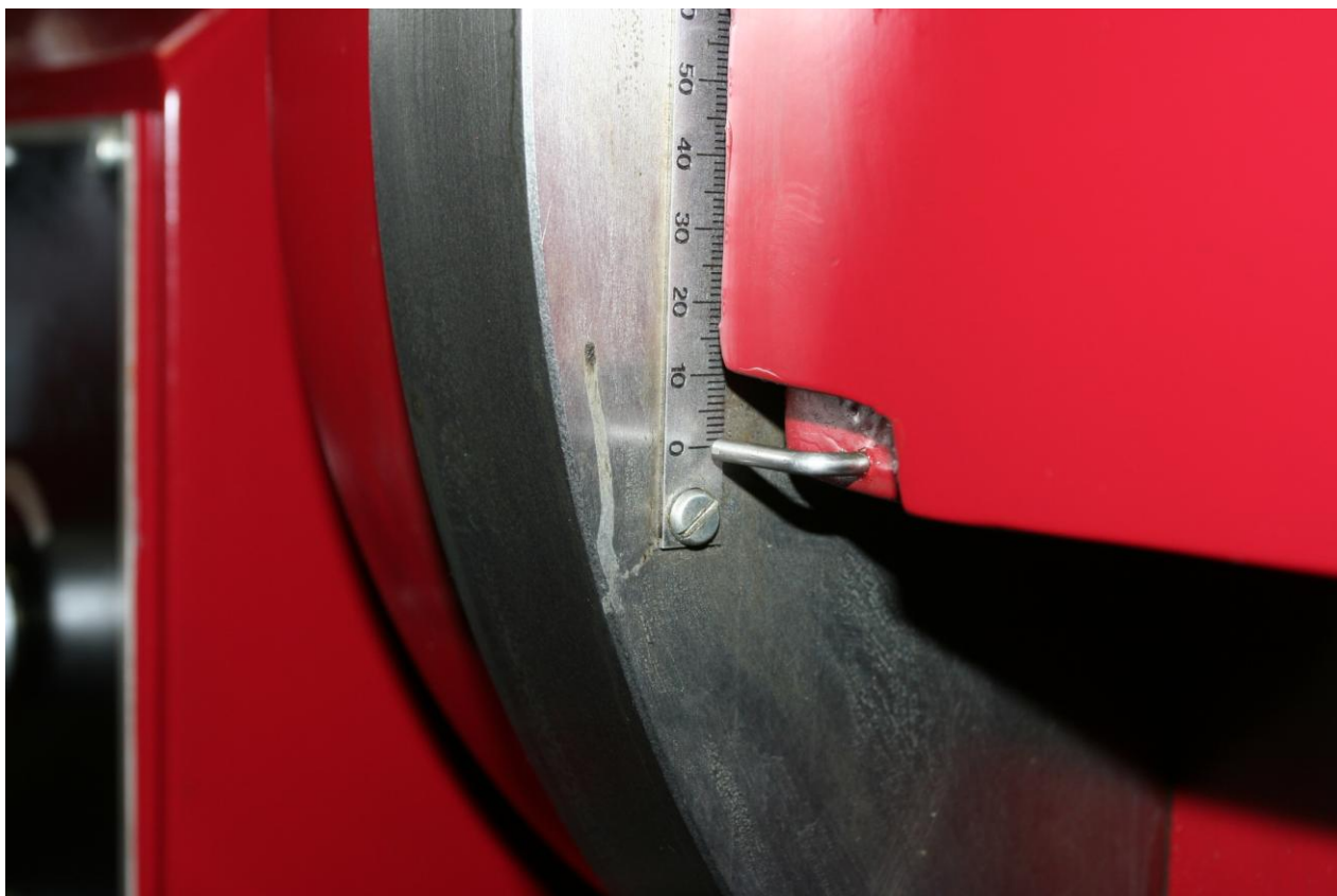
Рис. 2.6. Контролировать нулевое положение противовесов по линейке на планшайбе.
