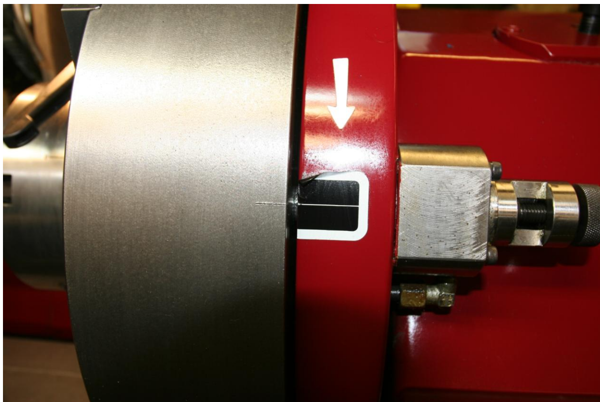
1.4. Установка планшайб станка в нулевое положение. Провернуть планшайбы вручную до совпадения рисок на планшайбе и бабке.
