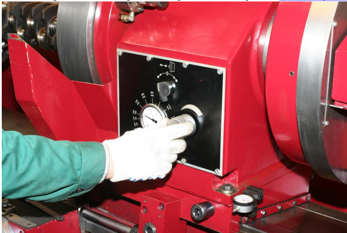
Рис. 2.13. Отрегулировать силу прижима заднего центра на минимальное значение рукояткой, контролируя ее по манометру. Проверить легкость вращения вала. После регулировки зажать пиноль бабки рукояткой, расположенной на задней бабке сверху.
