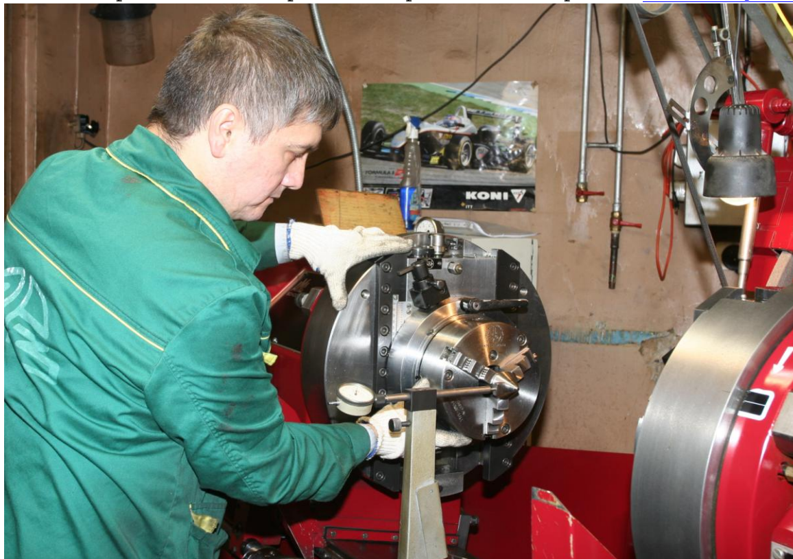
Рис. 2. 9. Поставить центроискатель на рабочую поверхность центра, нажать педаль, чтобы освободить планшайбы, и проверить биение центра.
