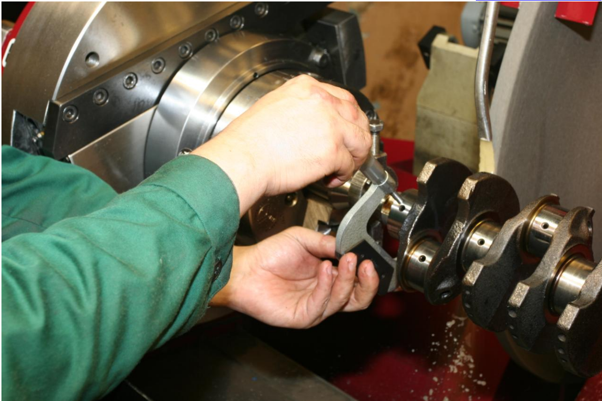
Рис. 2.21. Отвести круг, выключить вращение вала, выполнить контроль размера шейки по окончании шлифования. Повторить операцию шлифования для других шеек.
