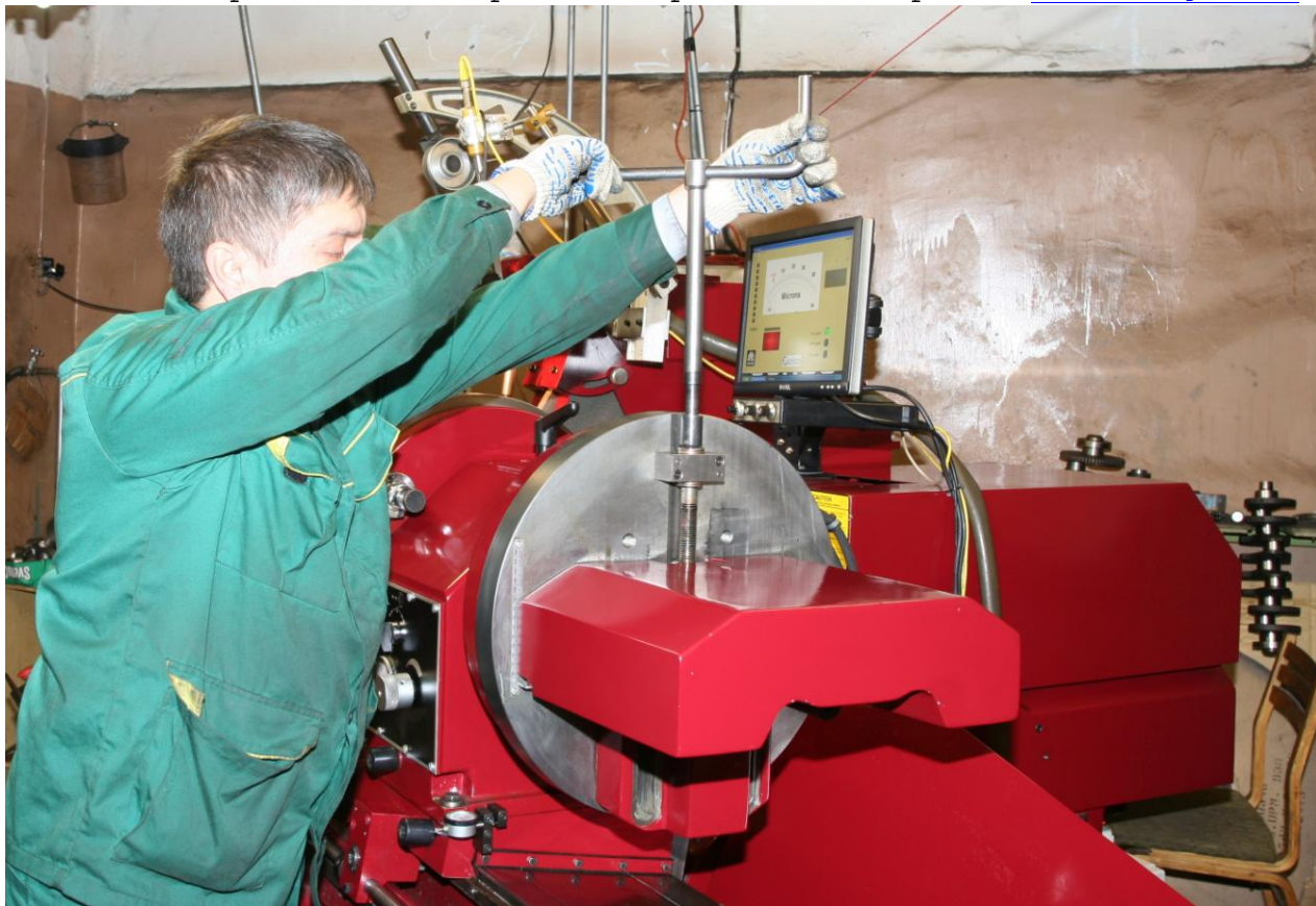
Рис. 2.5. Установить противовесы в нулевое положение, вращая регулировочный болт.
