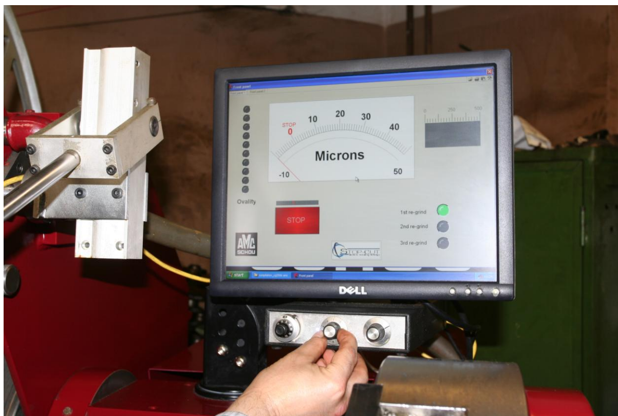
Рис. 1.34. Отрегулировать прибор EAM – установить размер ремонтного уменьшения шейки и момент остановки шлифования. Подробное описание работы прибора содержится в Инструкции эксплуатации станка и в Инструкции по эксплуатации прибора EAM.
