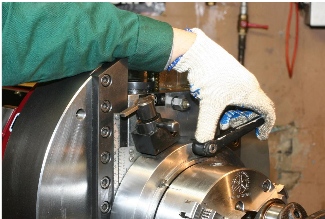
Рис.1.17. Ослабить рукоятку фиксации патрона на планшайбе передней бабки, повернув ее против часовой стрелки.
