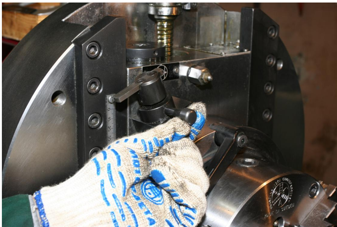
Рис. 1.25. Отрегулировать поперечное биение шейки вала с помощью рукоятки (при ослабленной фиксирующей рукоятке). Точность выставления вала – не хуже чем 0,03 мм. При регулировке обеспечить рукояткой изменение показаний индикатора на половину величины поперечного биения. После окончания регулировки затянуть фиксирующие рукоятки патронов.
