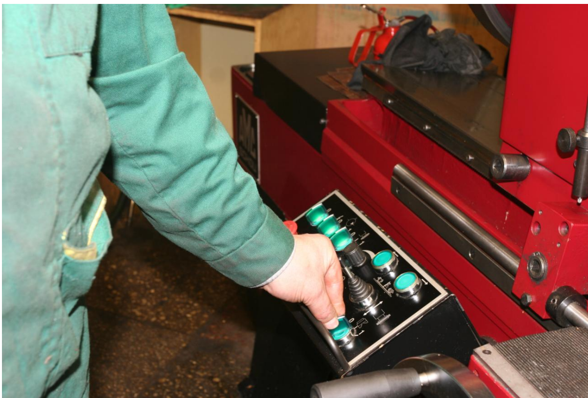
Рис. 1.29. Включить вращение вала для проверки правильности установки противовесов.
