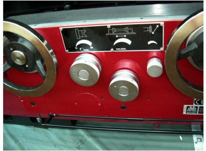
4.5. Проверить легкость ручной подачи стола, вращая **левый** штурвал на станине при выключенной гидравлической подаче.
