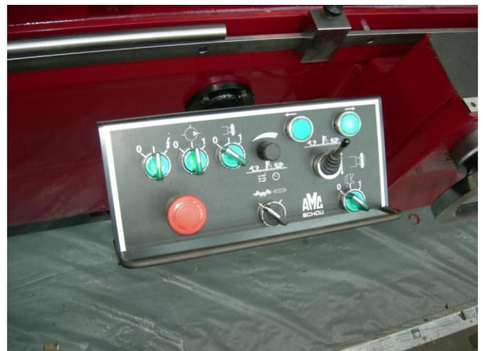
4.4. Отрегулировать длительность задержки остановки стола в крайних положениях регулятором **в центре** пульта. Наблюдать за перемещениями стола вправо и влево. При необходимости отрегулировать скорость перемещения стола, поворачивая **средний регулятор** на станине станка. Выключить подачу стола.
