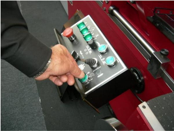
4.9. Включить на пульте управления вращение шпинделя передней бабки, повернув по часовой стрелке до упора **крайний правый** переключатель. При необходимости отрегулировать скорость вращения, поворачивая левый регулятор на станине.
