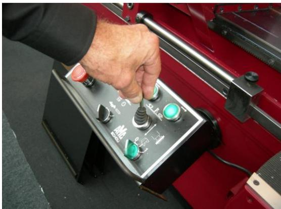
4.13. Проверить быструю гидравлическую подачу шлифовального круга. Поставить переключатель режимов шлифования в левое положение (шлифовка коленвалов), **нажать** педаль. Рычагом управления подачей на пульте передвинуть круг в переднее положение (рычаг перевести в нижнее положение) или заднее положение (верхнее положение рычага).
