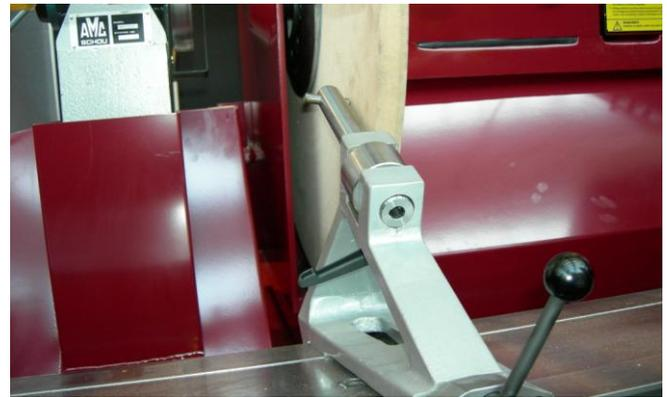
4.17. Отрегулировать подачу охлаждающей жидкости с помощью крана и специальной форсунки, входящей в комплект станка.
