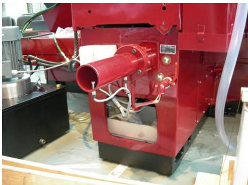
в) направляющие шлифовальной бабки – прозрачные окна сзади (максимум и минимум), залить масло (12 л), подняв кожух, расположенный ниже корпуса шпинделя спереди (см. рис.б).
