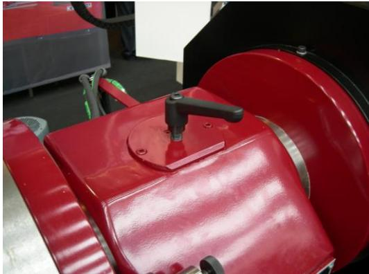
4.11. Ослабить зажим полый оси задней бабки, отвернув фиксирующий винт.
