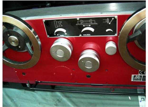
4.15. Проверить вращение шлифовального круга. Включить вращение поворотом 3-го слева выключателя на пульте до упора по часовой стрелке. Дать кругу поработать в режиме свободного вращения в течение нескольких минут, избегая находиться в плоскости вращения круга.
