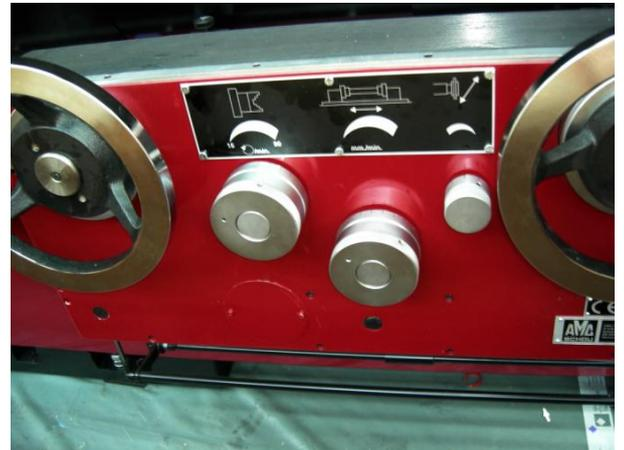
4.12. Включить гидравлическое перемещение планшайбы, повернув выключатель на задней бабке в требуемую сторону. Манометр для контроля усилия зажатия вала (это усилие регулируется вращением регулятора) будет показывать величину усилия только при движении в крайнее левое положение или в случае, если вал установлен в центрах. Зафиксировать положение оси задней бабки винтом.
